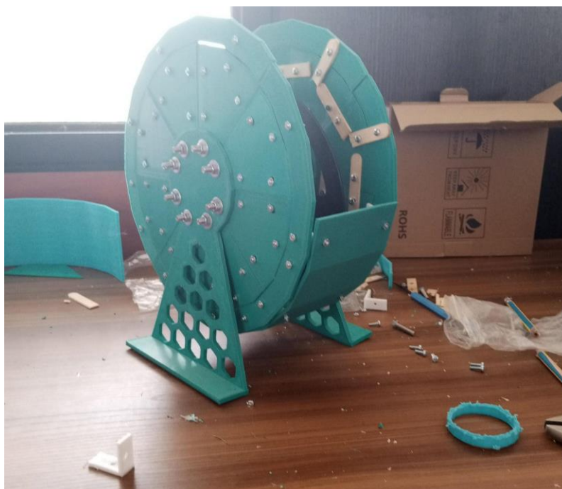
Fig. 66. Ensamblaje final de las 37 piezas del calefactor.
