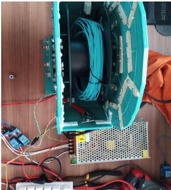
Fig. 70. Restauración de la fibra PLA cristalizada mediante calefacción.
