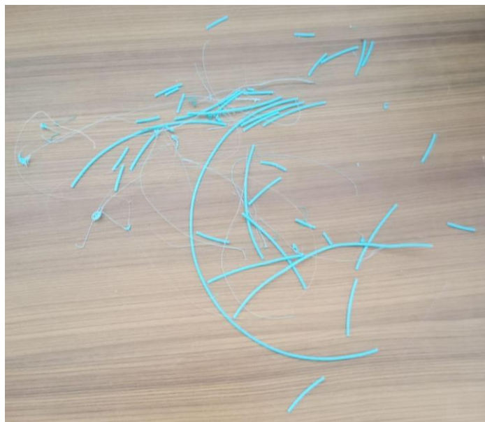
Fig. 67. Problemas de cristalización en la fibra PLA durante el proceso de impresión.
