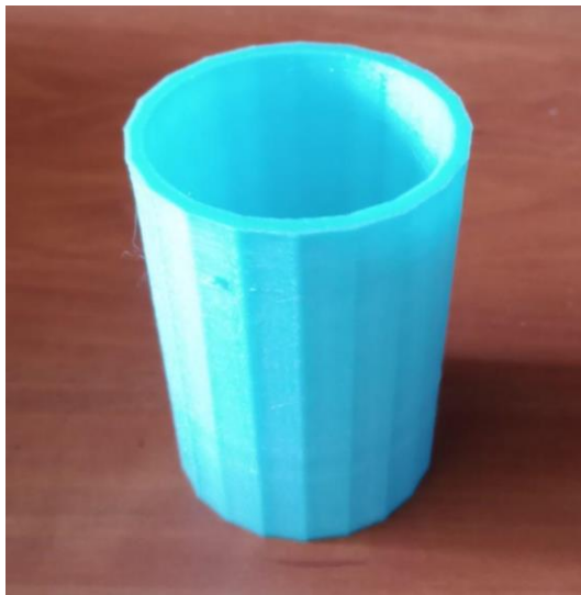
Fig. 15. Vista previa del cilindro hueco impreso para dar soporte al rollo fibra.
