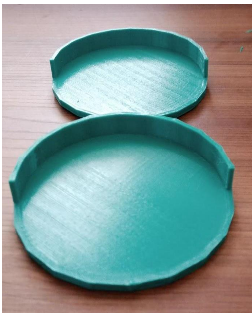
Fig. 10. Impresión de los soportes para el rollo de filamento PLA y PET.
