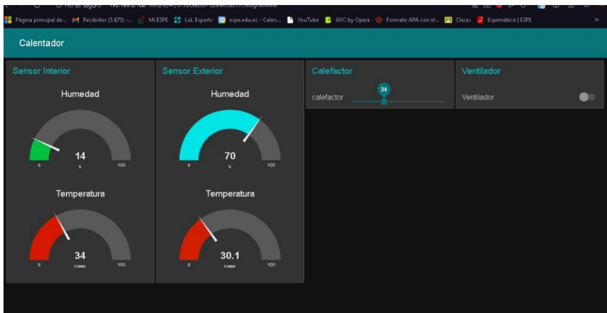
Fig. 68. Control de temperatura con margen de error en Node-RED.
