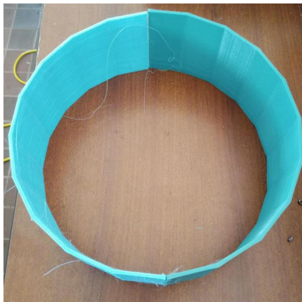
Fig. 14. Impresión de la cubierta del calefactor.
