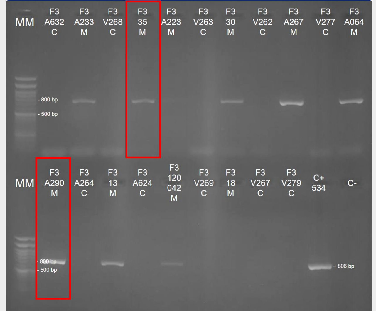
FIGURA 10. ELECTROFORESIS DEL PRODUCTO DE PCR/MSP5 EN GEL DE AGAROSA 1,5%, TRANSILUMINADOR UV
