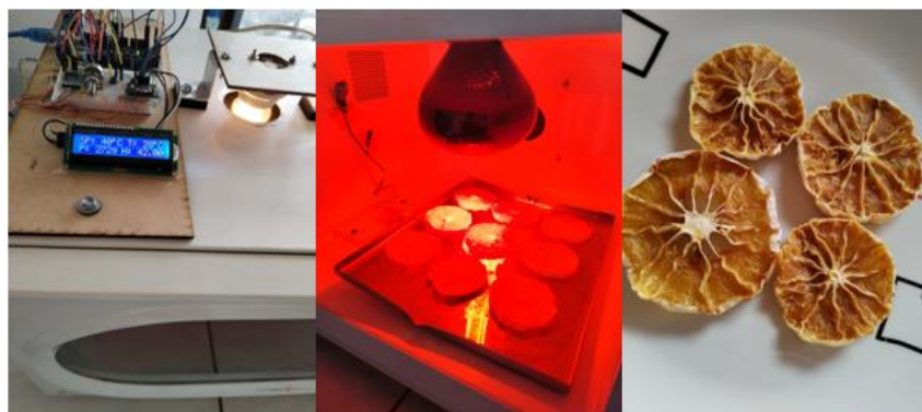
Pruebas de deshidratación de 250g de naranja a 40°C
