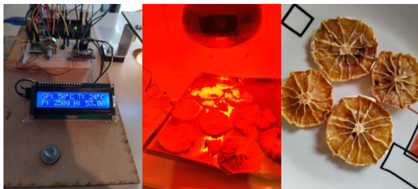
Pruebas de deshidratación de 250g de naranja a 50°C
