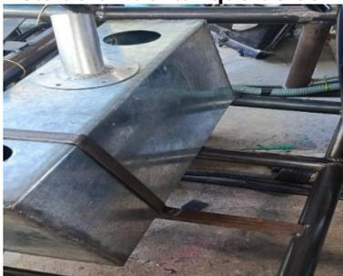
**8. Instalación del tanque de combustible**
