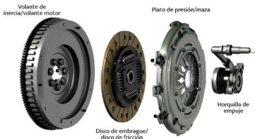
*Nota.* Embrague de fricción. Tomado de *tipos de sistemas de embrague y sus partes*, por Frenkit.
