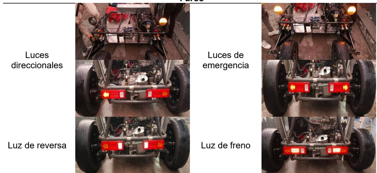
*Nota.* La tabla ilustra las pruebas de funcionamiento del sistema de iluminación.
