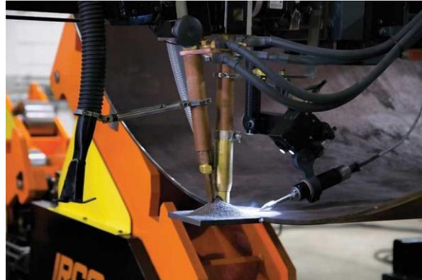
*Nota.* La producción de tubos es una aplicación donde cobra sentido la soldadura por arco sumergido. Tomado de (THE FABRICATOR, 2018)
