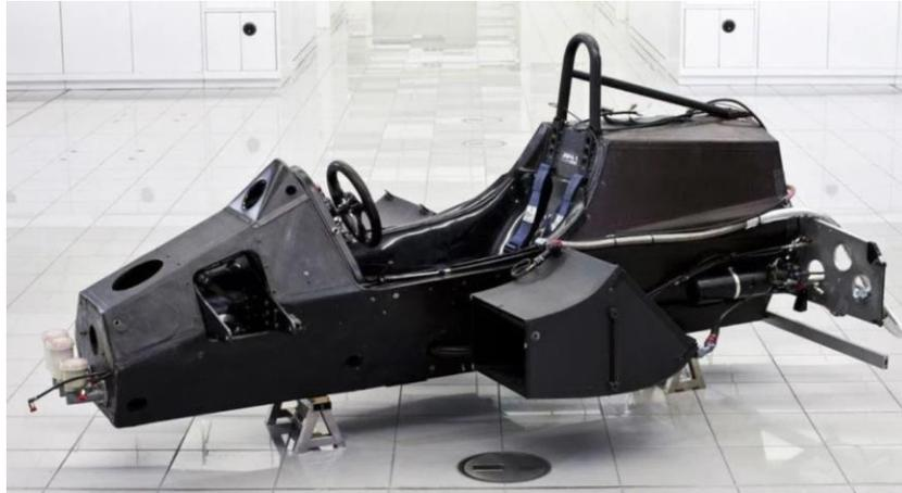
*Nota.* La figura muestra el primer chasis monocasco de fibra de carbono fabricado por McLaren. Tomado de (Álvarez, 2016).
