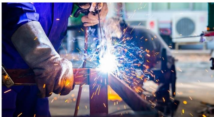
*Nota.* La SMAW recibe muchos nombres, entre ellos: soldadura por arco con electrodo revestido, soldadura con electrodo recubierto, soldadura manual de arco metálico y soldadura de varilla. Tomado de (Grupo Acura, 2023)
