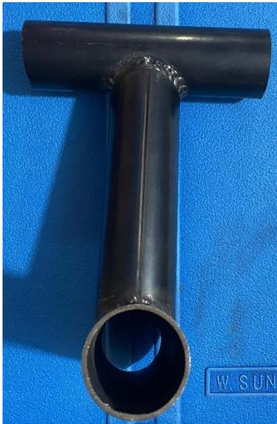
Para el procedimiento del ensayo no destructivo de soldadura mediante líquidos penetrantes se siguió el método anteriormente descrito, por lo que, inicialmente, se procedió a limpiar la muestra a examinar. Esta no es una limpieza exhaustiva, por lo cual se lo hizo con un trapo limpio y un poco de agua.
