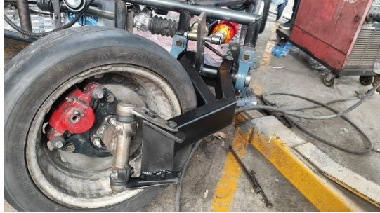
Soportes de la barra de empuje
