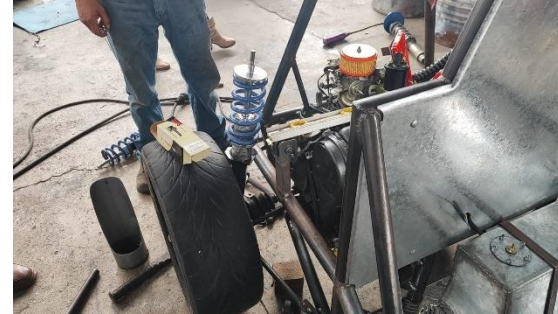
Implementación del amortiguador
