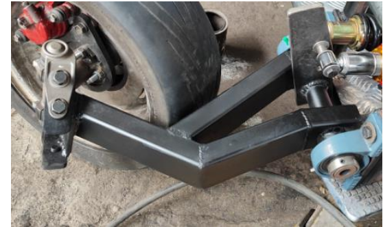
Instalación del brazo dirección
