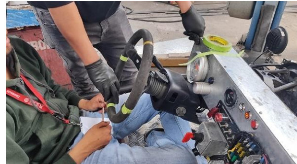
Ubicación de la columna de dirección
