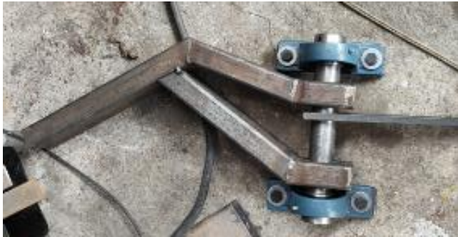
Fabricación del brazo de dirección
