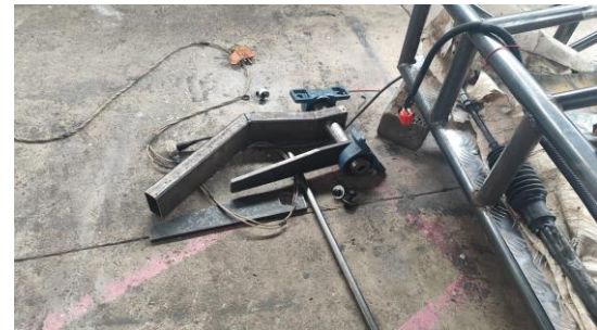
Ubicación de chumacera y sujeción del brazo
