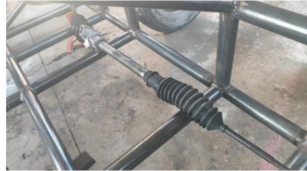
Ubicación de la columna de dirección
