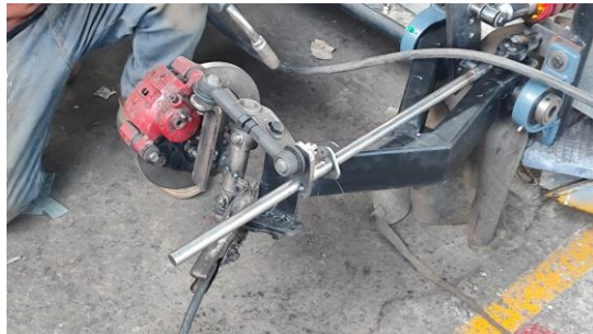
Soportes de la barra de empuje
