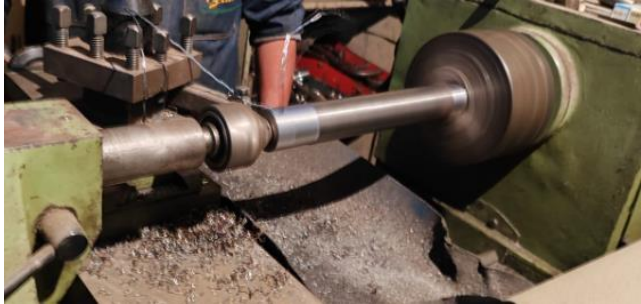
Fabricación del brazo de dirección
