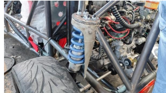
Instalación de los amortiguadores posteriores
