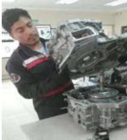
*Nota.* En la Figura se presenta el armado de un motor generador del vehículo híbrido Toyota Highlander.
