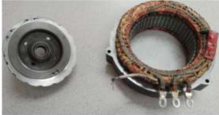
*Nota.* El motor generador 1 es el encargado de funcionar como un motor de arranque en los sistemas híbridos, los motores generadores 1 cumplirán su función de carga muy similar a la aplicación que mantiene un alternador en el vehículo convencional.
