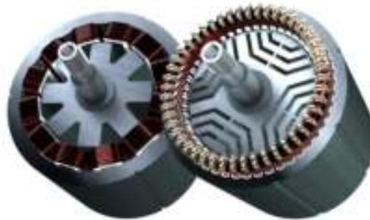
*Nota.* Los motores de reluctancia siempre necesitan un número diferente entre álabes del rotor y los polos que se encuentran en el estator, esto se debe a que cuando unas bobinas del estator generen campos magnéticos deben alinearse solo unos polos del rotor y no todos al mismo tiempo. Tomado de (Oswos, 2022).
