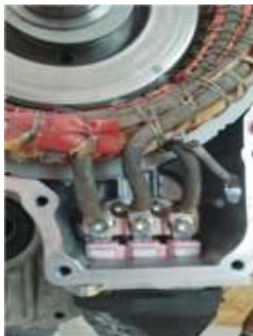
*Nota.* En la figura se puede observar el ajuste de las conexiones eléctricas de un estator del motor generador, en donde se ocupa debidamente los terminales y pernos de ajuste, garantizando una adecuada conexión a masas y alimentaciones.
