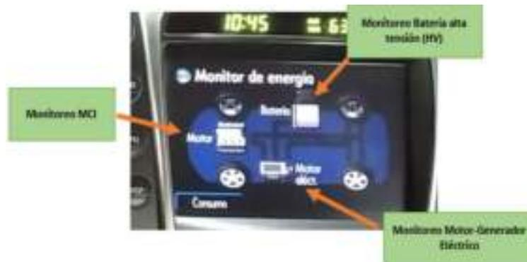
*Nota.* En la siguiente imagen se puede observar un sistema de monitoreo incorporado en el vehículo, en donde al empezar su funcionamiento esta hace un análisis de los sistemas de un vehículo híbrido.
