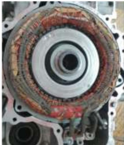
*Nota.* El electroimán que se encuentra en el centro de la estructura bobinada, es el imán permanente como un rotor y la bobina es el estator.
