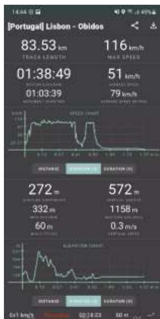
*Nota.* La imagen indica la aplicación proporciona datos numéricos y gráficas sobre la altitud, velocidad media en función de los kilómetros recorridos. Tomado de (Shop, 2023)
