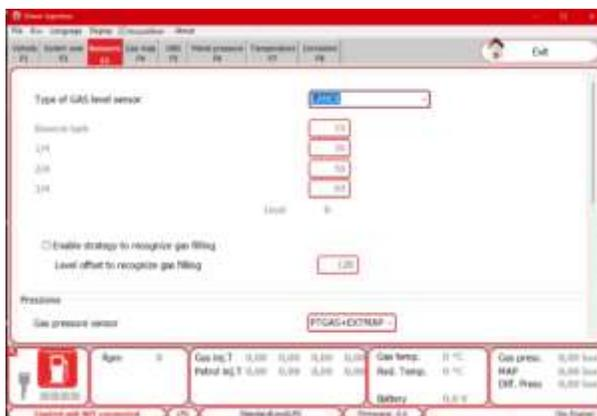
*Nota.* La imagen indica el nivel de GLP existente en el depósito y proporciona valores referenciales a 1/4, 2/4 y 3/4 de llenado.
