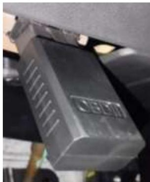
*Nota.* La imagen muestra la conexión establecida de OBDII con el puerto DLC del vehículo de ensayo
