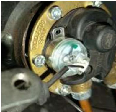
*Nota.* La imagen señala al indicador lleno del nivel de pluma del carburante en el depósito
