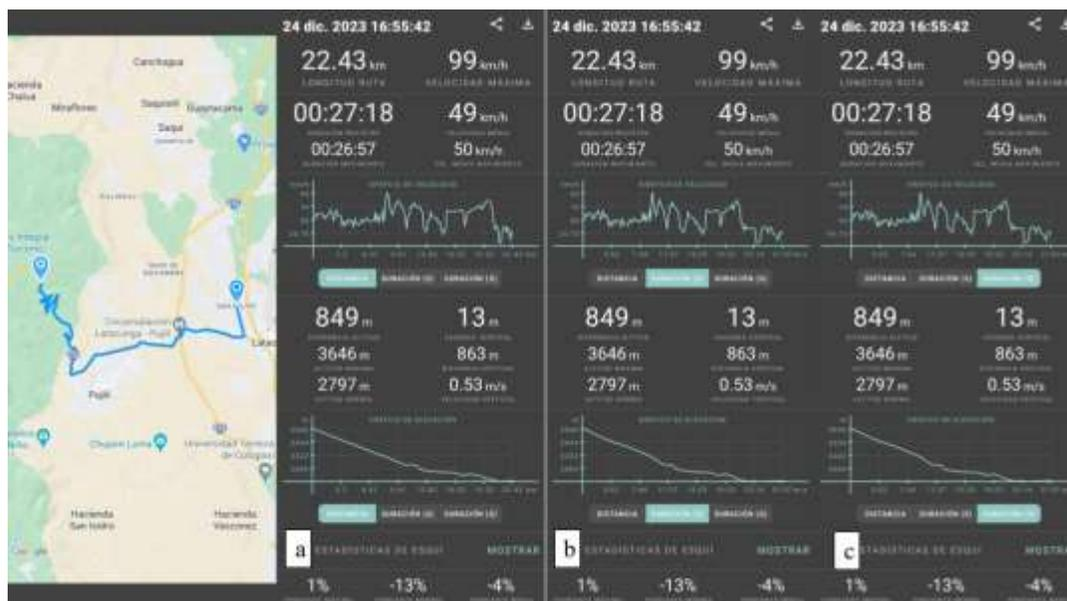
*Nota.* La imagen indica los datos finales de las condiciones de manejo de la ruta combinada con gasolina. a) Gráfica de distancia (km/h vs km) y elevación (m vs km). b) Gráfica de duración (km/h vs m:s) y elevación (m vs m:s). c) Gráfica de duración (km/h vs m:s) y su elevación (m vs m:s)
