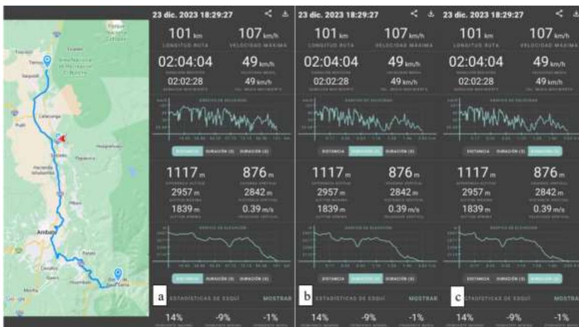
*Nota.* La imagen indica los datos finales de las condiciones de manejo de la ruta de autonomía con gasolina. a) Gráfica de distancia (km/h vs km) y elevación (m vs km). b) Gráfica de duración (km/h vs m:s) y elevación (m vs m:s). c) Gráfica de duración (km/h vs m:s) y elevación (m vs m:s)
