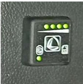
*Nota.* La imagen señala el conmutador para pasar de gasolina a DUAL e indicador de leds de nivel del carburante GLP.
