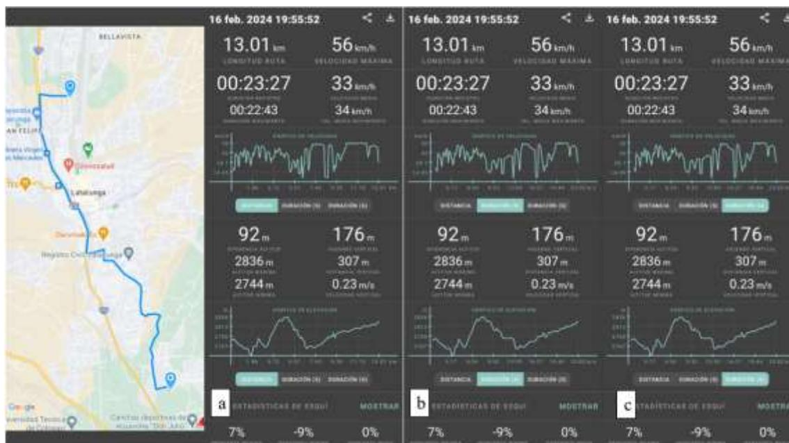
*Nota.* La imagen indica los datos finales de las condiciones de manejo de la ruta urbana con carburante GLP. a) Gráfica de distancia (km/h vs km) y elevación (m vs km). b) Gráfica de duración (km/h vs m:s) y elevación (m vs m:s). c) Gráfica de duración (km/h vs m:s) y elevación (m vs m:s)
