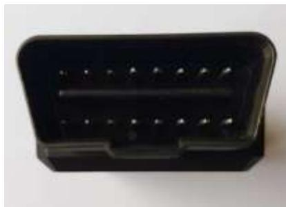
*Nota.* La ilustración indica el OBD II de 16 pines para establecer comunicación con el vehículo de ensayo.
