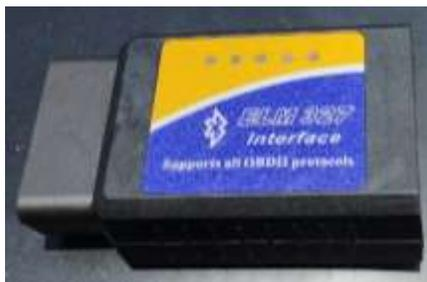
*Nota.* La imagen indica la interfaz para obtener parámetros del vehículo de ensayo
