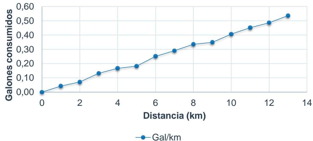
El análisis de la gráfica revela el consumo de combustible durante un trayecto urbano específico. Se destacan variaciones significativas, particularmente en los tramos de 3 a 4 kilómetros y de 6 a 8 kilómetros de la ruta. En el primer tramo, se registró un consumo de 0,04 galones, mientras que en el segundo tramo el consumo ascendió a 0,09 galones
