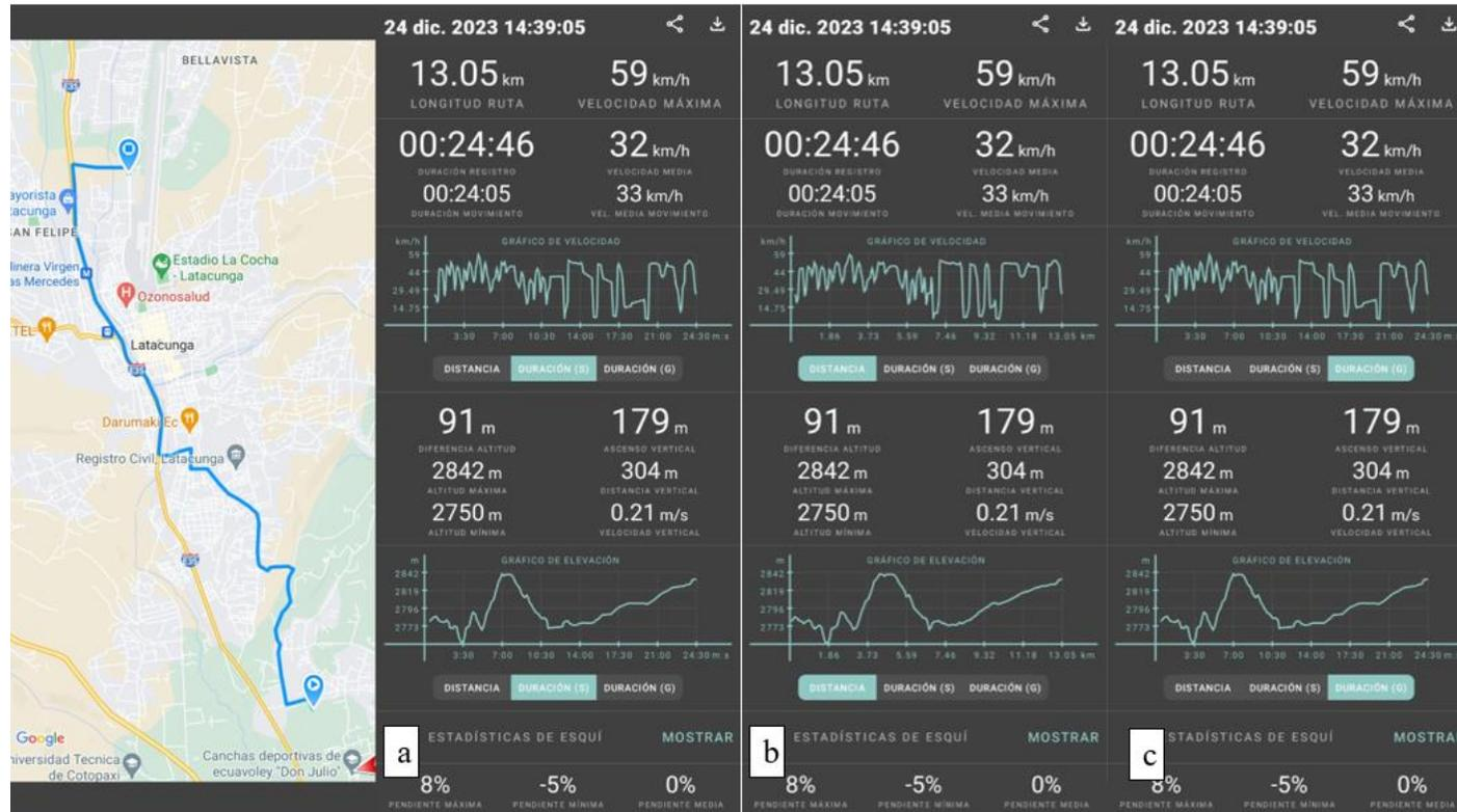
La imagen indica los datos finales de las condiciones de manejo de la ruta urbana con gasolina. a) Gráfica de la duración (km/h vs m:s) y la elevación que existió (m vs m:s) . b) Gráfica de la distancia de la ruta (km/h vs km) y su elevación (m vs km). c) Gráfica de la velocidad (km/h vs m:s) y su elevación (m vs m:s)
