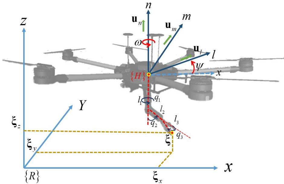
$$\begin{bmatrix} \dot{\xi}_x \\ \dot{\xi}_y \\ \dot{\xi}_z \\ \dot{\omega} \\ \dot{q}_1 \\ \dot{q}_2 \\ \dot{q}_3 \end{bmatrix} = \mathbf{J}_{A4x7} \begin{bmatrix} u_l \\ u_m \\ u_n \\ \omega \\ \dot{q}_1 \\ \dot{q}_2 \\ \dot{q}_3 \end{bmatrix}$$
