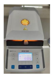
Nota. Resultado de humedad de la muestra del aceite de uva con el equipo de humedad.
