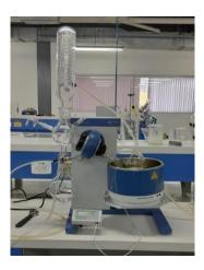
Nota. Separación del disolvente y del aceite de arazá con el equipo rota vapor.
