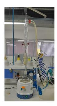
Nota. Ensamble del método de extracción de soxhlet para el aceite de arazá.
