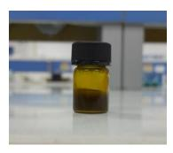
Nota. Almacenamiento del aceite de arazá extraído con el método de soxhlet en un vial.
