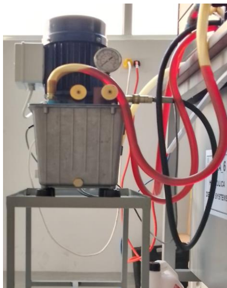
Bomba hidráulica - Sistema de Alimentación
