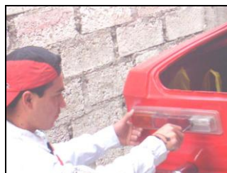
Figura 6.31 armado de las luces posteriores.
