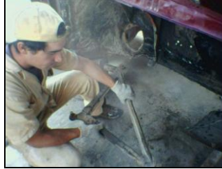
Figura 4.5 Desmontaje del brazo de la suspensión.
