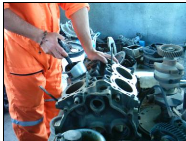
Figura 2.8 Ajuste del pistón dentro del cilindro
