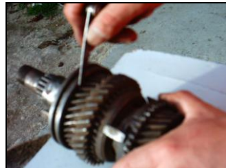
Figura 3.16 Medición con un calibrador de láminas
