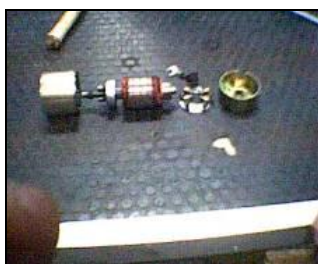
Figura 6 .2 Desmontaje del motor de arranque.
