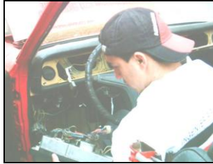
Figura 6.26 Armado del tablero de instrumentos.
