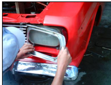
Figura 6.21 Armado de faros.
