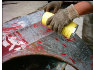
Figura 5.5 Aplicación de removedor.
