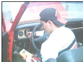
Figura 6.29 Verificación de los acopladores.
