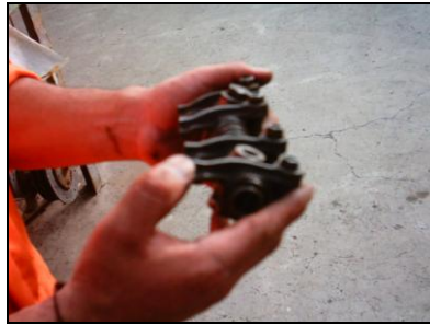
Figura 2.14 Inspeccionar la rampa de balancines
