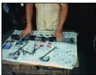
Figura 4. 21 Inspección de la dirección.
