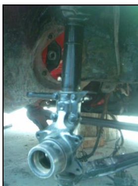
Figura 4. 11 Instalación del conjunto puntal.
