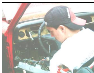
Figura 6.30 Montaje del panel de control.
