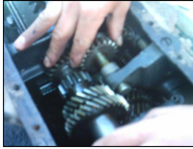
Figura 3. 23 Cómo retirar /instalar el ensamble del eje principal en una transmisión.
