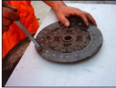
Figura 3. 6 Verificación de la excentricidad y deformación del disco
