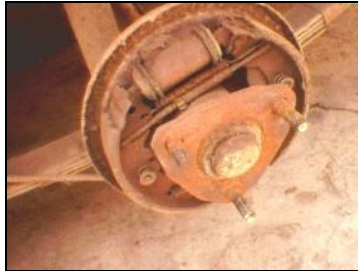
Figura 4.34 Desmontaje tambor de freno
