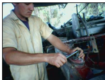
Figura 4. 10 Apretar la tuerca del puntal al par requerido.
