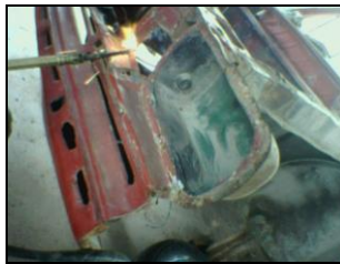
Figura 5.6 Soldar y enderezar la parte delantera.
