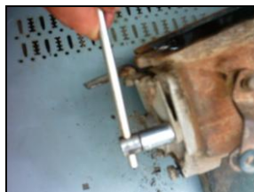
Figura 3. 10 Desarmado de la transmisión
