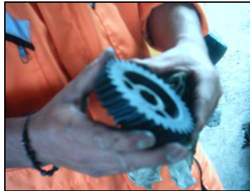
Figura 2.13 Comprobar el desgaste de los engranajes
