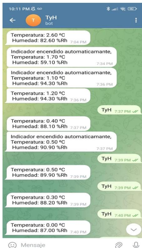
Ya realizada la prueba para indicar el envío de alerta de forma automática, se retira el módulo del refrigerador haciendo que la temperatura aumente de forma progresiva, el indicador led del módulo se apaga de forma automática al sobrepasar los 6°C, y de igual manera envía un mensaje indicando que el indicador se apagado. En la Figura 25, se muestra el mensaje automático recibido a Telegram.
