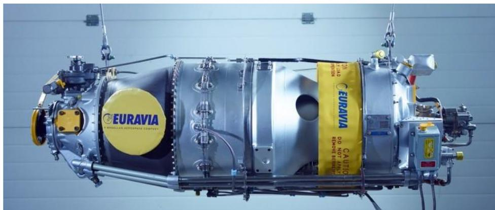
*Nota.* Prototipo de motor que dispone la aeronave Cessna Grand Caravan 208B. Tomado de *Motor—PT6A-114A*. (s. f.). Recuperado 23 de septiembre de 2023, de <https://www.euravia.aero/engine-detail/pt6a-114a?locale=en>
