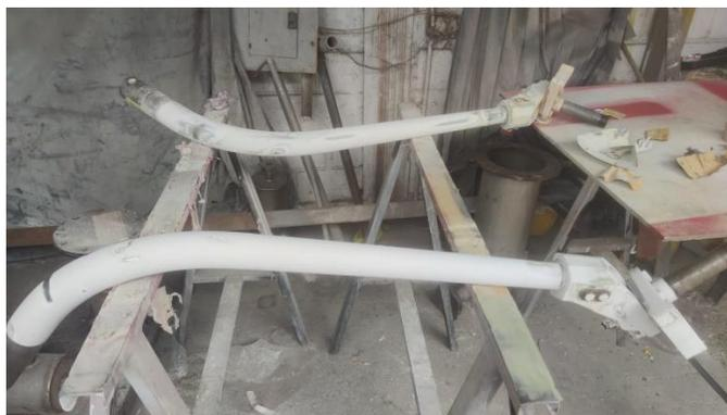
*Nota.* Se retira la pintura de la estructura para aplicación de líquido anticorrosivo seguido por la pintura que se procede a dejar secar durante un día al aire libre para su próxima instalación.
