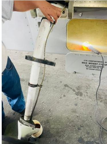
*Nota.* Se verifica el estado de cañerías, y remoción de las mismas para facilidad de inspección de soporte de tren e identificarlas para instalación una vez finalizada la inspección.
