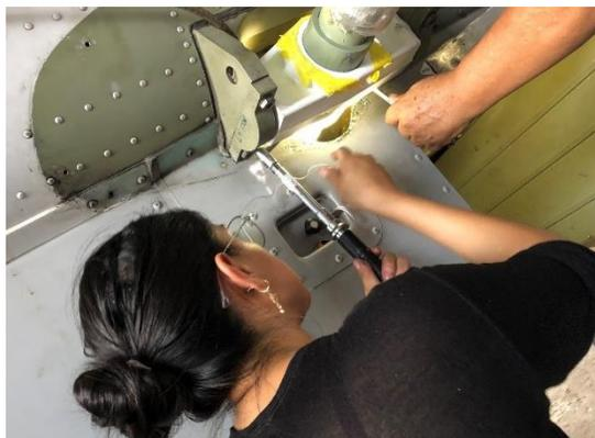
*Nota.* El ajuste de los pernos ayuda a tener una estabilidad de seguridad entre los componentes anteriormente instalados, para ello se debe aplicar un torque en cada uno de los pernos de sujeción.
