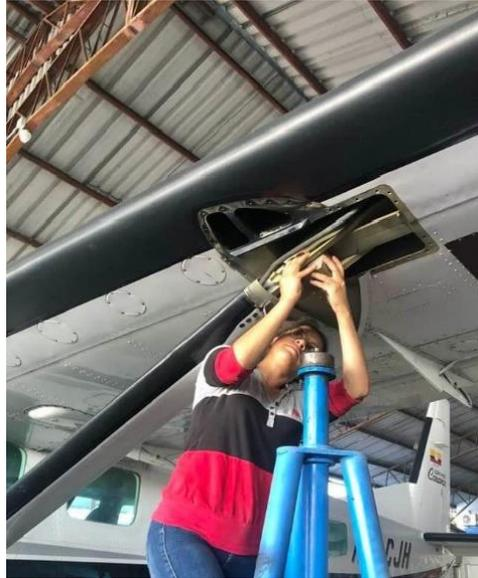
*Nota.* Ajuste de los puntos de anclaje con los soportes hidráulicos.
