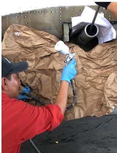
*Nota.* Antes de instalar por completo el muelle central se debe aplicar pintura (primer) en la superficie externa e interna del mismo.
