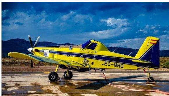
*Nota.* Configuración de posición de tren de aterrizaje con patín de cola. Tomado de (*Cuántos tipos de tren de aterrizaje hay, s. f.*)
