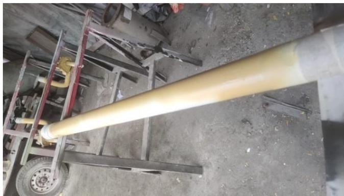
*Nota.* Realizado la limpieza y aplicación de protección anticorrosivo se aplica pintura blanca y dejar reposar al aire libre.
