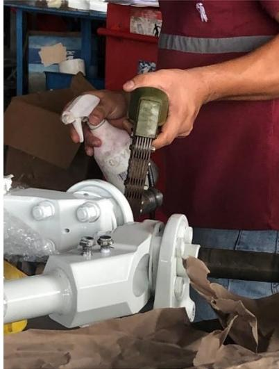
*Nota.* Aplicación de partículas magnéticas a soportes de neumático verificando la existencia de imperfección. *Fuente propia.*
