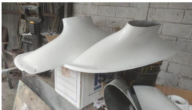
*Nota.* Los carenados ayudan a la estructura de soporte de tren de aterrizaje que se mantenga en condición y que no ingrese factores ambientales a su estructura.
