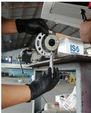
*Nota.* Se necesita un micrómetro con una tolerancia de +0,001 ó -0,001 pulgadas (+0,025 ó -0,025 mm) para realizar esta medición.
