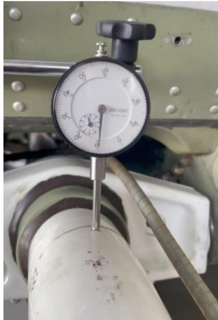
*Nota.* Mediante el uso de un reloj dial se permite verificar que el free play este entre los parámetros delimitados por el fabricante, así se determina que la instalación es correcta.
