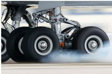
*Nota.* Tren de aterrizaje de aeronave tipo Airbus, avión comercial. Tomado de (Tren de Aterrizaje, EcuRed. (s. f.))
