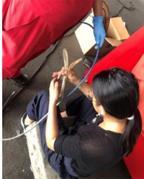
*Nota.* La inspección facilita verificar el estado de las cañerías, se remueve el protector de calor alrededor de la línea de cañería para reemplazo.
