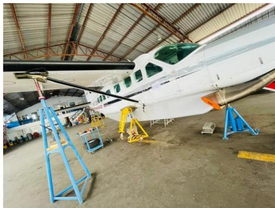
*Nota.* Ilustración de aeronave completamente izada en soportes hidráulicos en cada punto específico en base a documentación técnica.
