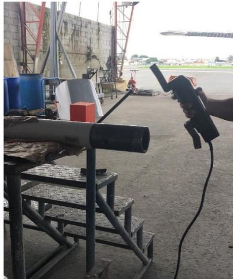
*Nota.* Al finalizar la aplicación de partículas magnéticas y visualizado mediante luz ultravioleta, se debe retirar el campo electromagnético de las superficies inspeccionadas optimizando que al
