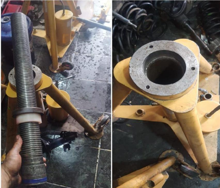
Nota. En la figura muestra el reemplazo de los O-rings en mal estado.
