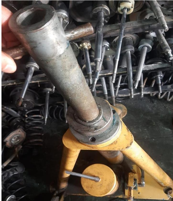
Nota. La figura muestra como se eleva el pistón del gato hidráulico con normalidad y se evidencia que no existe fuga de líquido hidráulico.
