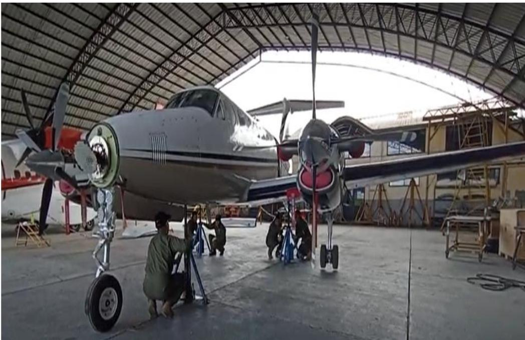
Nota. La figura ilustra al personal técnico colocando los gatos hidráulicos en los puntos de elevación de la aeronave.
