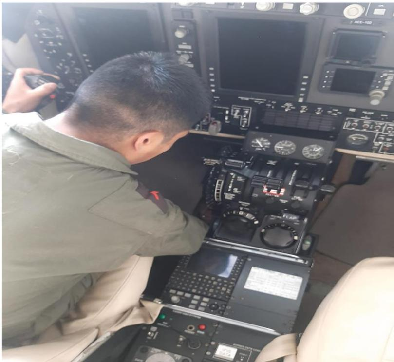
Nota. La figura muestra la accionamiento de la palanca para realizar una retracción del tren por emergencia.
