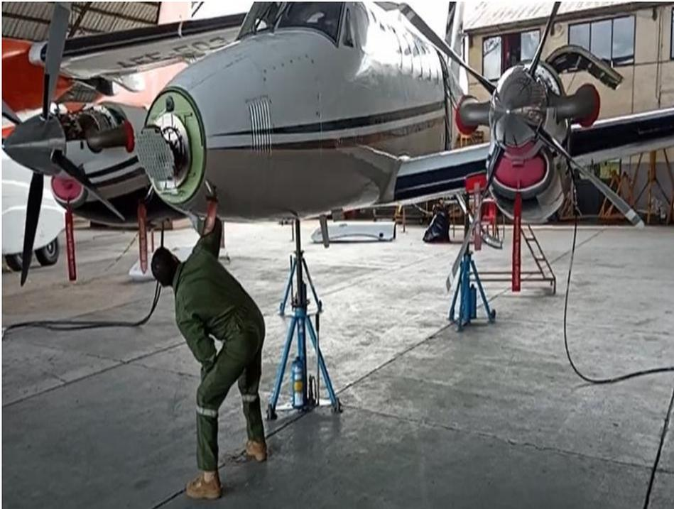
Nota. La figura demuestra el control del reglaje de la `puerta del tren de nariz de la aeronave
