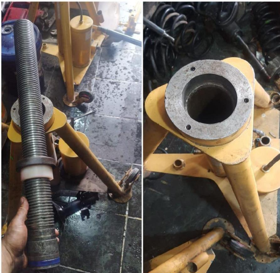
Nota. La figura ilustra el desmontaje del pistón tipo rosca para retirar los O-ring en mal estado.
