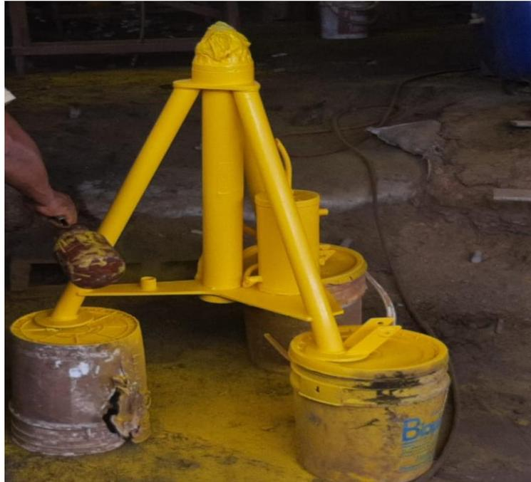
Nota. La figura ilustra la aplicación de pintura color amarillo a los gatos hidráulicos mismas que quedaran en buenas condiciones para su operación
