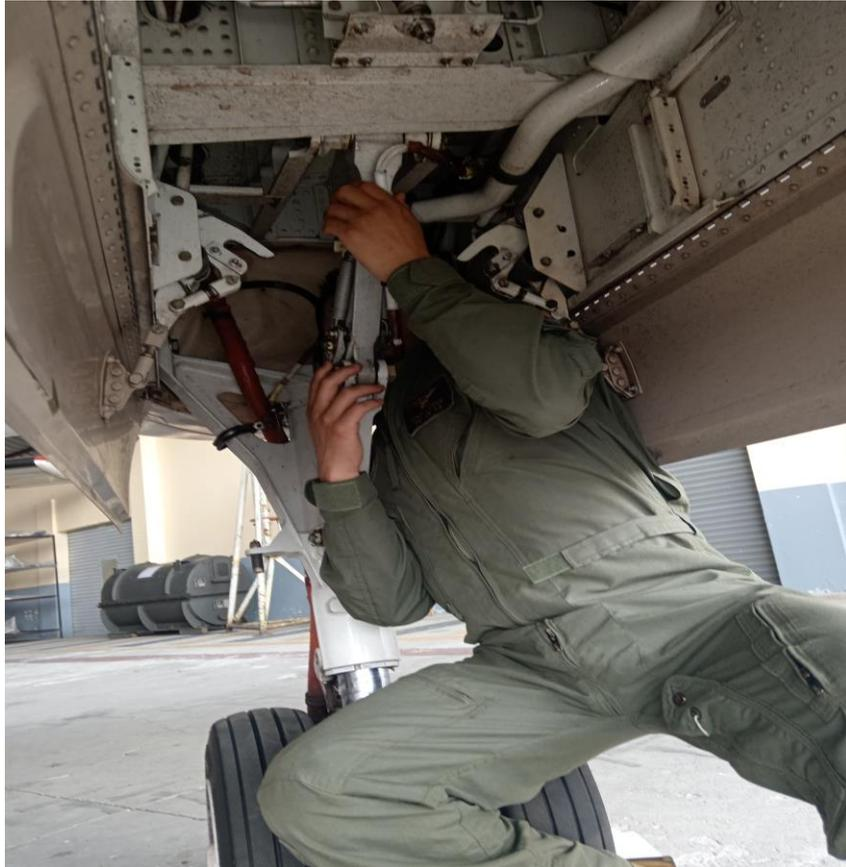
Nota. La figura ilustra el momento donde se verifica el actuador se encuentre extendido del tren principal de la aeronave.
