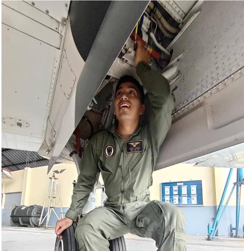
Nota. La figura ilustra la verificación del perno superior de torsión del tren de aterrizaje de la aeronave.
