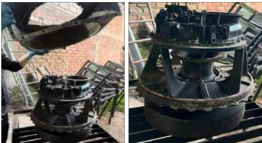
Cobertor de la zona fría de la APU
