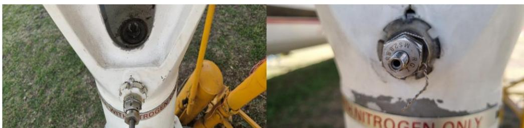
Luego se procedió a conectar la el pivot de carga de la bombona de nitrógeno hacia la boca de la válvula de carga del strut.
