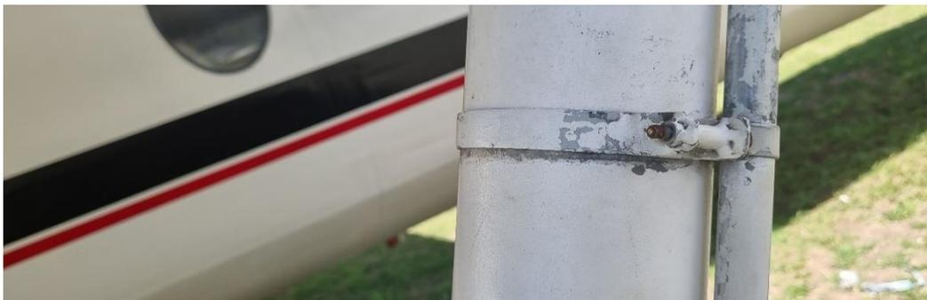
El procedimiento para dar solución a este problema, constó de la remoción de las abrazaderas con su respectiva ferretería (pernos, tuercas y arandelas) para remplazarlas con ferretería nueva.
