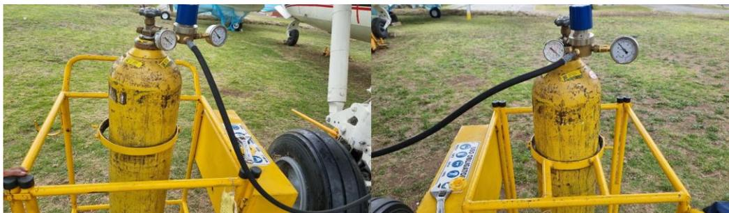
Posteriormente se abrió la válvula de carga de nitrógeno del strut, para la cual se utilizó una llave 3/4, girando la tuerca media vuelta sentido antihorario.
