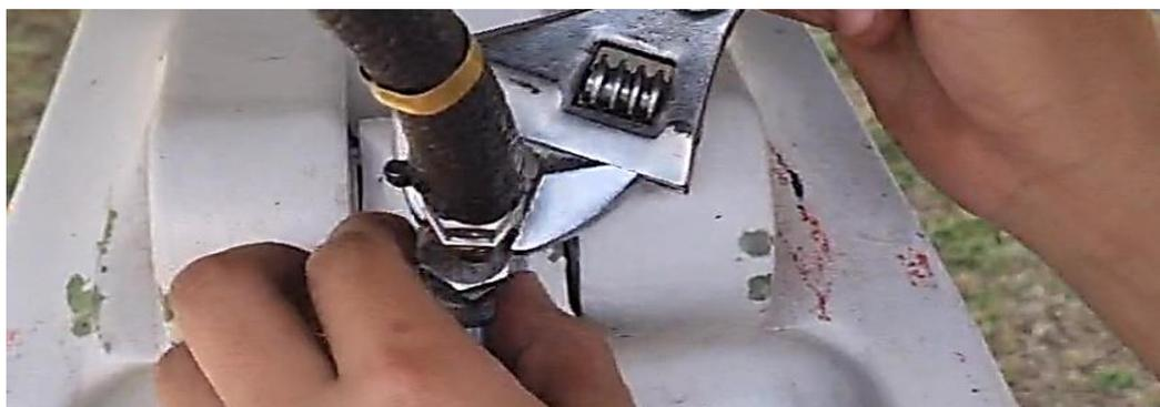
Ya habiendo retirado el acople de la boca de la válvula de carga retiró el equipo de carga de nitrógeno, se inspecciono visualmente el cambio que generó en el amortiguador y se limpió.
