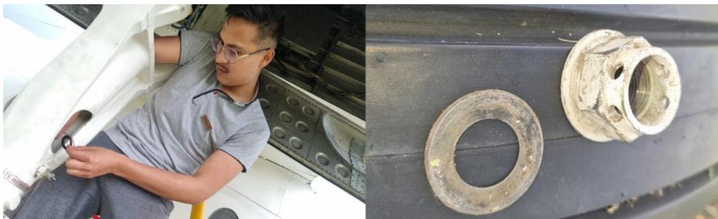
*Nota.* Las tuercas de seguridad se extrajeron con sus arandelas, 2 flexibles y 1 rígida.
