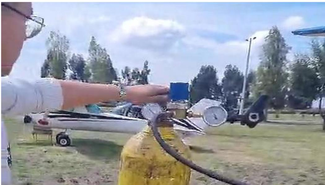
En consiguiente se abrió la llave del manorreductor progresivamente trabajando en conjunto con el manómetro de baja presión, sabiendo que este indica la presión enviada al shock absorber. Según recomendación del manual se abrió la llave de carga de nitrógeno hasta alcanzar el valor numérico exacto de 1000psi en el manómetro de baja presión cumpliendo con el requerimiento especificado.
