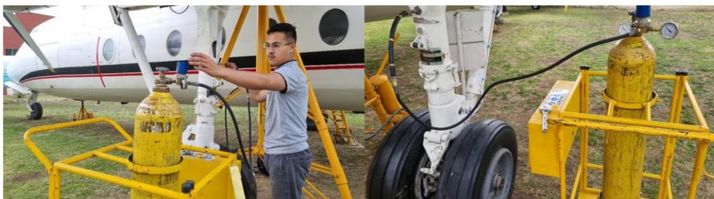
En consiguiente se procedió a girar en sentido horario media vuelta la tuerca de seguridad de la válvula de carga del strut, para que se pueda retirar el pivot sin que la presión puesta en el componente sea expulsada y como paso final, se retiró el equipo de carga de nitrógeno de la zona del tren de aterrizaje y se culminó con la carga de nitrógeno.
