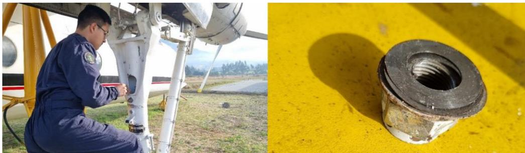
*Nota.* Se extrajeron las tuercas de seguridad con sus arandelas, dos flexibles y una rígida.
