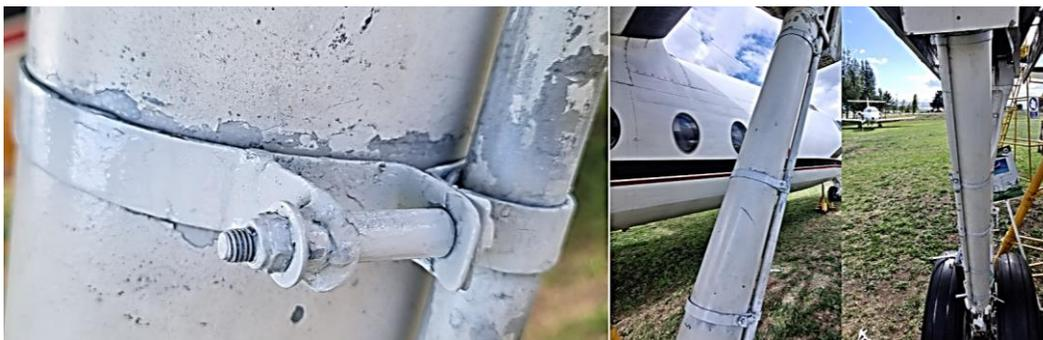
Finalmente se inspeccionó los rodamientos y puntos móviles, verificando que no tengan juego entre rodamientos y pernos de sujeción y que todo esté en perfecto estado.
