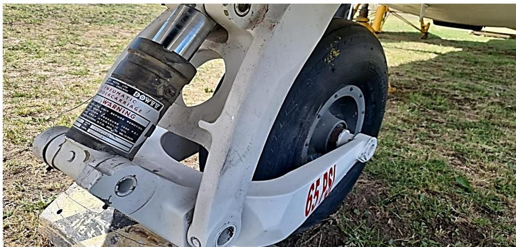
**Inspección estructural del tren de aterrizaje de nariz.** Inicialmente la inspección se llevó a cabo realizando un chequeo de todas las partes que sujetan el shock absorber. Se inspeccionó fugas en el gland housing y se verificó el nivel de humectación en el cilindro móvil, determinando que no existe fugas por presión, por empaques y ni un exceso de lubricación.
