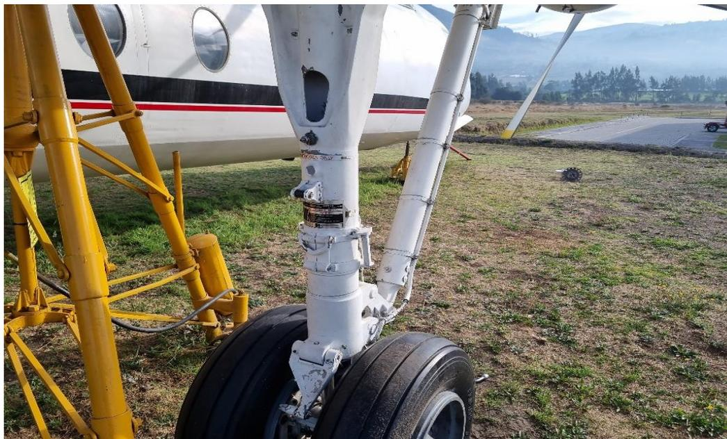
Inspección estructural del tren de aterrizaje principal. Inicialmente la inspección se llevó a cabo realizando un chequeo detallado de todas las partes conjuntas al miembro de bloqueo del amortiguador, como lo es el lock strut que todo esté en perfecto estado estructural y funcional, verificando que no exista riesgo de movimiento, que pernos y tuercas estén ajustados y seguros.
