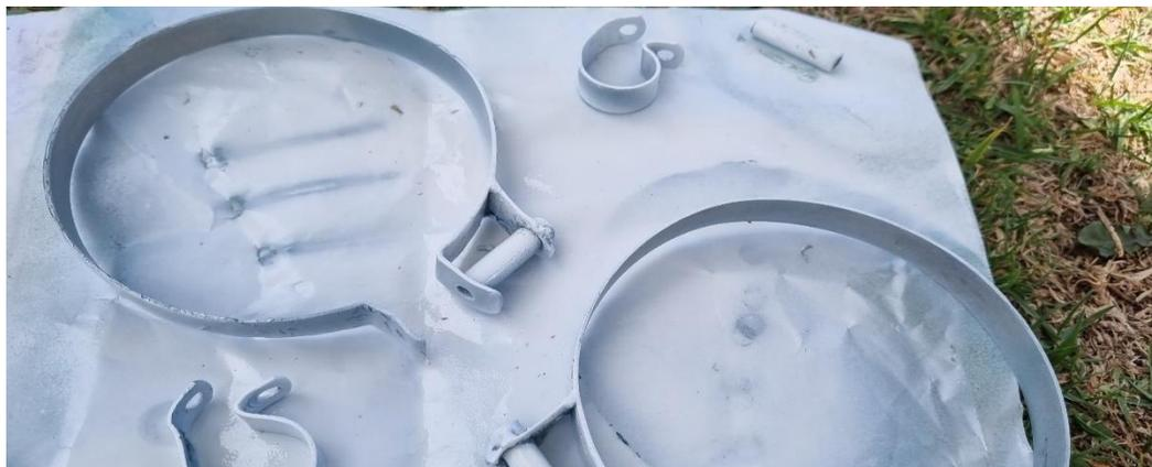
Ya habiendo realizado el proceso de pintado, se continuó con el armado de las abrazaderas, pernos, tuercas y arandelas al drag stay del tren de aterrizaje principal derecho.
