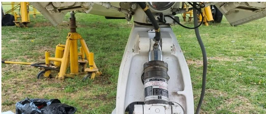
Después de liberar completamente el amortiguador sin carga, se retiraron los pernos de servicio. Para terminar el trabajo, se fijó la cabeza del perno del amortiguador con una llave inglesa y se giró el perno en sentido antihorario. Tenga en cuenta que el componente tiene dos pernos de servicio.
