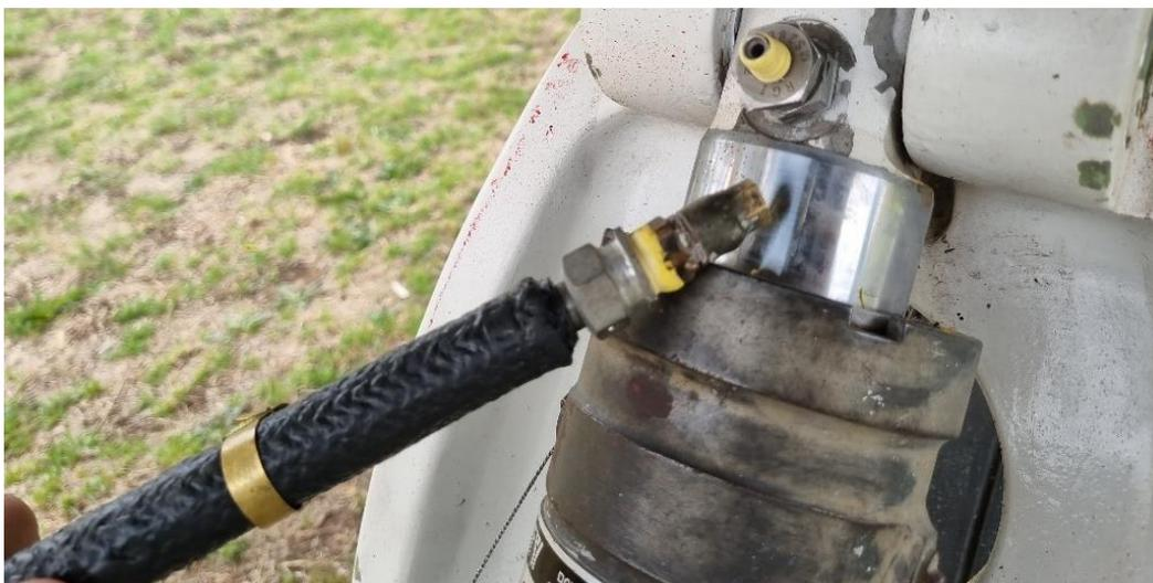
Para la carga, inicialmente se embonó el pivot en la boca de válvula de carga y con el uso de una llave se giró la tuerca de seguridad de la válvula de carga del shock absorber media vuelta sentido antihorario.
