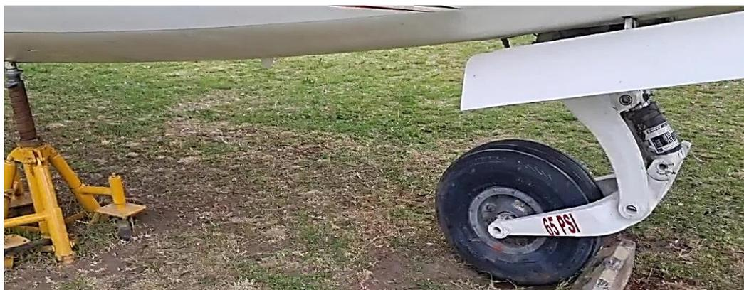
Se retiraron los pernos de servicio después de liberar completamente el shock absorber sin carga. Para completar la tarea, se fijó la cabeza del perno del amortiguador con una llave inglesa, girando el perno en sentido antihorario para recordar que el componente tiene dos pernos de servicio.
