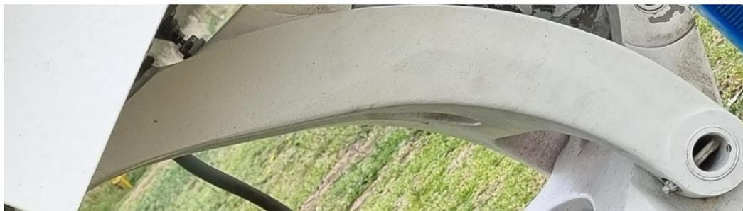
El wheel lever forma parte del sistema de flexión del tren, por ende, de la misma manera se inspeccionó su estructura por presencia de rajaduras y grietas, determinando totalmente libre de discrepancias.
