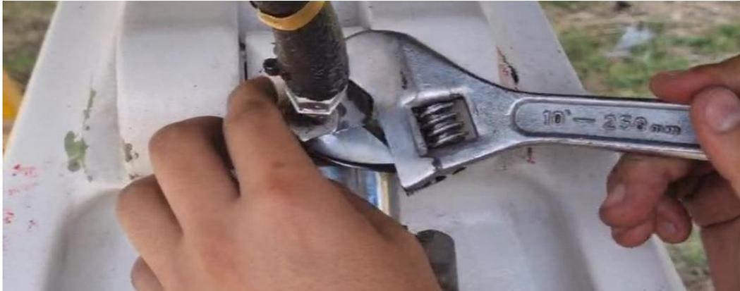
Posteriormente se realizó la apertura total de la llave de paso de la bombona, permitiendo así el flujo de nitrógeno por el sistema, marcando el manómetro de alta 2300psi de presión enviados al manorreductor.
