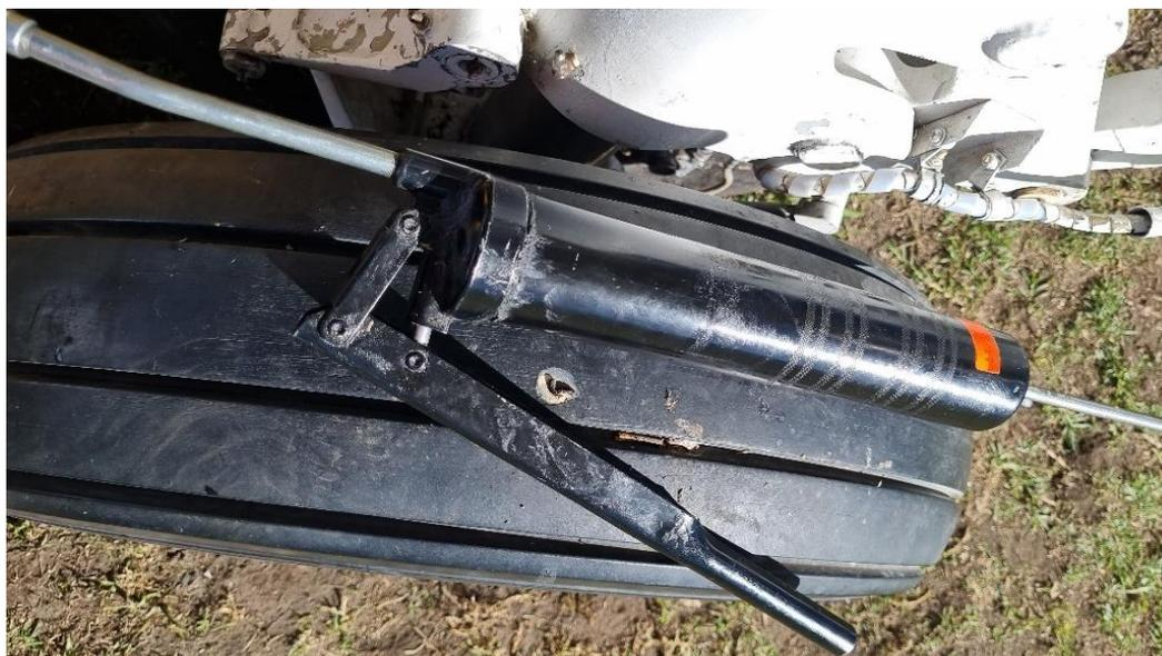
El engrasado en el tren de nariz se realizó sin dificultades, indicando que se aplicó la grasa hasta que este brote mínimamente del componente, entendiendo que se llenó la cámara interior del componente, ocasionando que esta sea expulsada al exterior por los bordes de los cojinetes.
