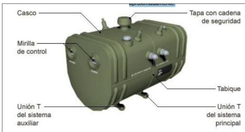
Tanque del sistema hidráulico
