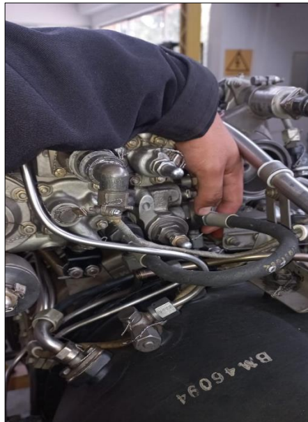
Conexión de la manguera de racores punta A al punto B
