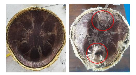
Nota. Se observa el antes y después del ensayo balístico, los círculos rojos indican las zonas donde se delamino la capa y es justamente en donde se traslapa la capa por cuestión de fabricación.
