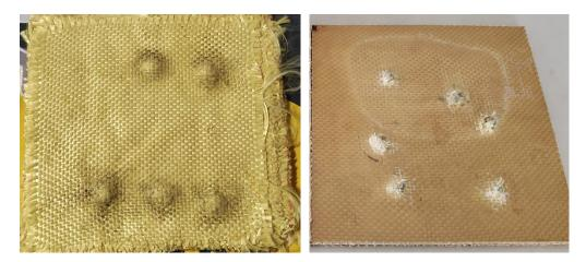
Nota. De izquierda a derecha probeta de tejido de fibra kevlar 49/ cemento de contacto y kevlar 49/ resina epoxi infusión.
