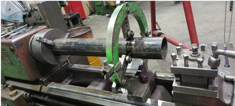
*Nota.* El proceso de refrentado se lo realiza con el propósito de dejar la superficie de la carcasa en condiciones adecuadas para soldadura de los otros componentes.
