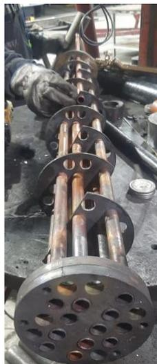
*Nota.* Se colocaron los baffles de forma intercalada con la finalidad de generar un flujo turbulento y mejorar la transferencia de calor.
