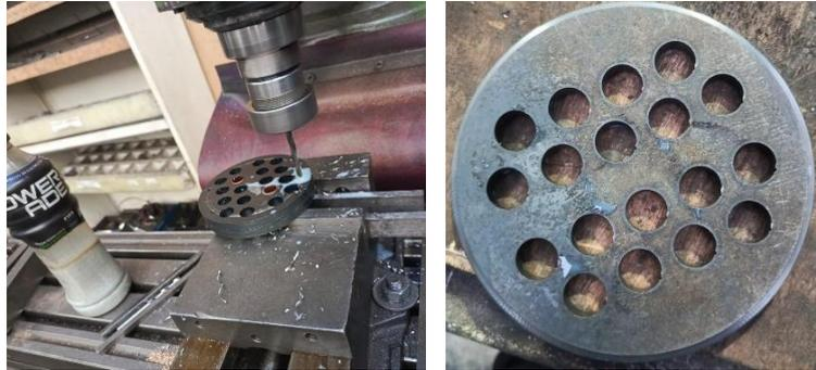
**Corte y perforación de los baffles de cobre**
