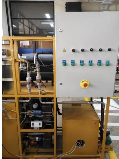
*Nota.* El tablero se fijó a la estructura por medio del empinado para asegurarlo de manera segura.
