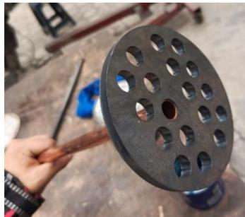
Como segundo paso se empleó el proceso de soldadura oxiacetilénica con varilla de plata al 15% como se observa en la figura 50, se soldaron cada uno de los tubos de cobre a la placa tubular por ambos lados para mayor seguridad y evitar fuga o mezcla de los fluidos de trabajo como se observa en la figura 51.
