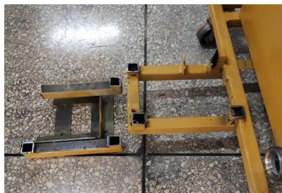
La modificación consistió en cortar la base antigua como se indica en la figura 65 y colocar la nueva base, como se aprecia en la figura 66.
