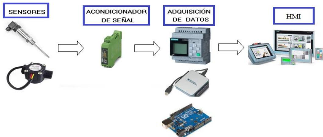
*Nota.* Se observa un ejemplo de cómo está conformado el sistema de adquisición de datos y como se da su funcionamiento desde la lectura de los sensores hasta su visualización en la HMI.
