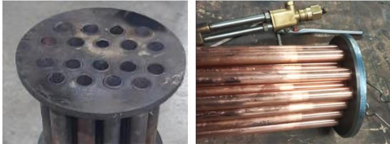
*Nota.* Al final se realizó una inspección visual para verificar imperfecciones, y adicionalmente se le aplicó una prueba hidrostática para determinar si era necesario corregir la soldadura.
