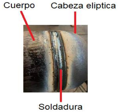
Figura 13 Soldadura de los cabezales semielípticos
