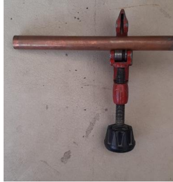
Figura 6 Corte y trazado de la tubería de cobre
