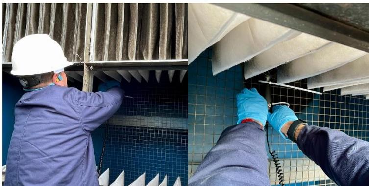
*Nota.* Colocación del ventilador a la entrada de aire a los turbocompresores.
