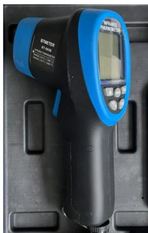
*Nota.* Utilizado para medir la temperatura de superficies externas del turbocompresor.
