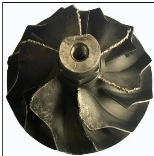
Desgaste de la rueda compresora
