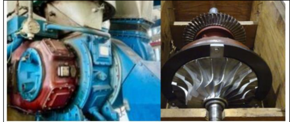
Figura 7: Fotografía del turbocompresor ABB VTR 354.
