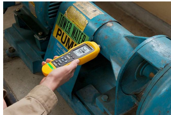
Monitoreo de Vibraciones
