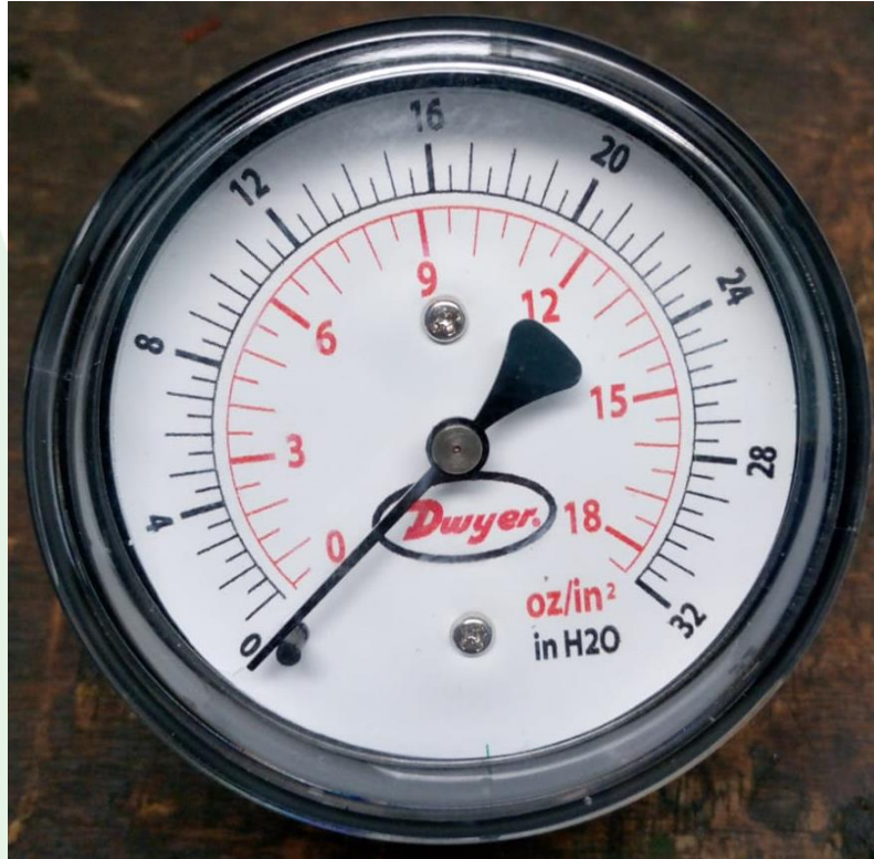
Figura 25. Medidor de presión utilizado como referencia para calibración.
