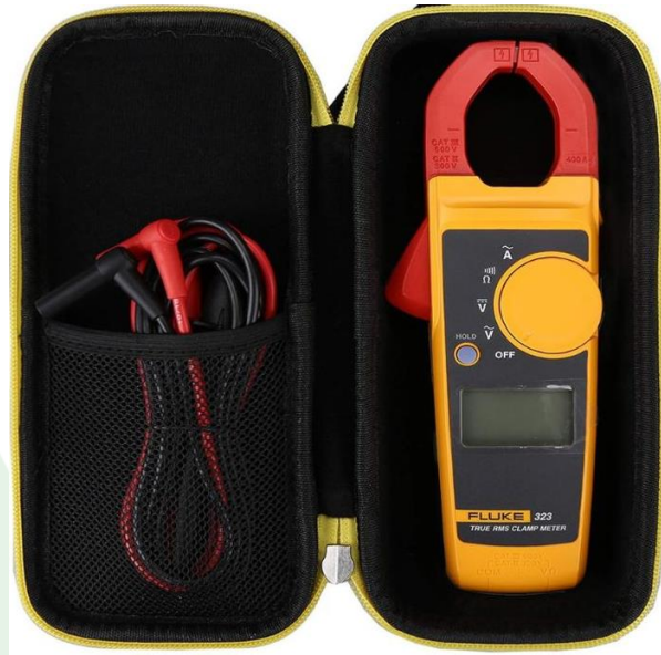
Figura 29. Medidor de corriente utilizado como referencia para calibración.
