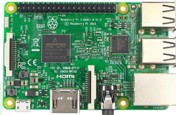
Figura 19. Componentes seleccionados. a) Raspberry Pi 3B. b) MPX5010DP. c) Termocupla tipo K. d) SCT-013. e) puente rectificador.
