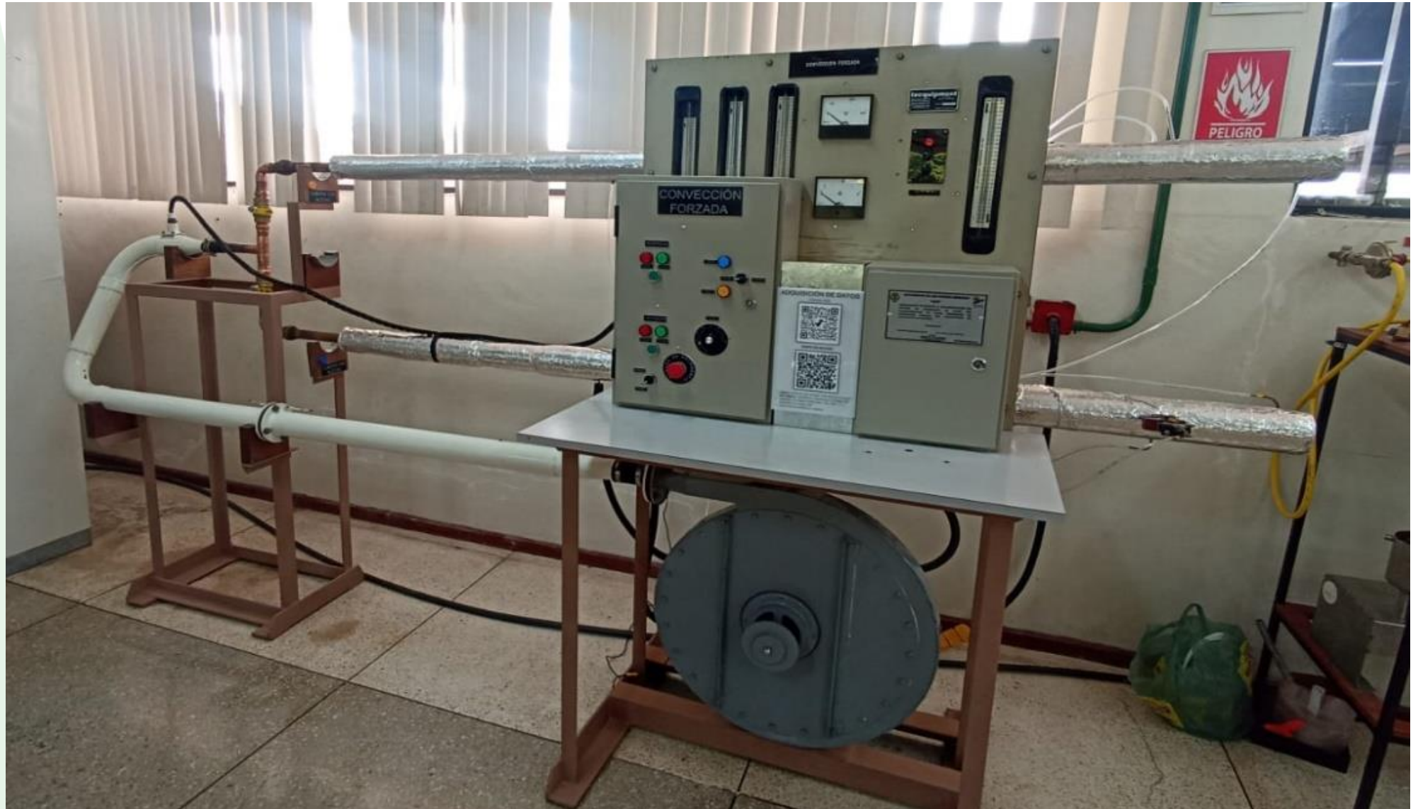
Figura 63. Unidad de transferencia de calor por convección forzada con sistema de adquisición de datos
