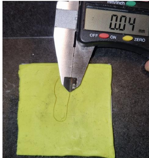
*Nota.* En la Figura 54 se observa el desfase que existe entre la primera y la tercera prueba de troquelado en el molde 3, siendo este un valor de 0.04 mm.
