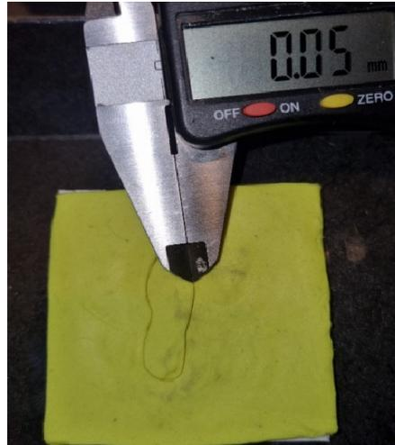
*Nota.* En la Figura 62 se observa el desfase que existe entre la primera y la quinta prueba de troquelado en el molde 3, siendo este un valor de 0.05 mm.
