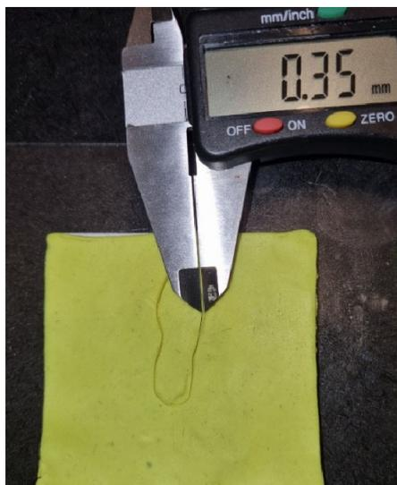
*Nota.* En la Figura 52 se observa el desfase que existe entre la primera y la tercera prueba de troquelado en el molde 2, siendo este un valor de 0.35 mm por lo que se evidencia un desfase considerable.
