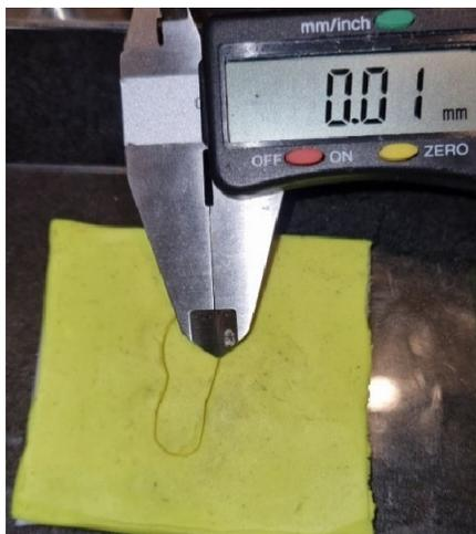
*Nota.* En la Figura 60 se observa el desfase que existe entre la primera y la quinta prueba de troquelado en el molde 1, siendo este un valor de 0.01 mm.
