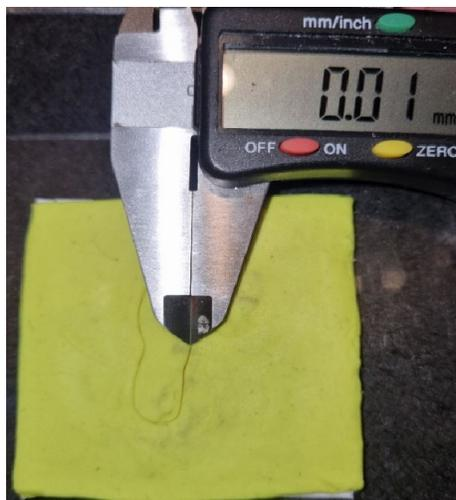
*Nota.* En la Figura 58 se observa el desfase que existe entre la primera y la cuarta prueba de troquelado en el molde 3, siendo este un valor de 0.01 mm.
