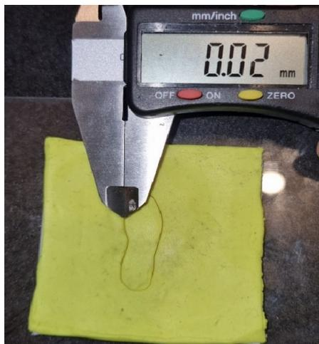
*Nota.* En la Figura 56 se observa el desfase que existe entre la primera y la cuarta prueba de troquelado en el molde 1, siendo este un valor de 0.02 mm.
