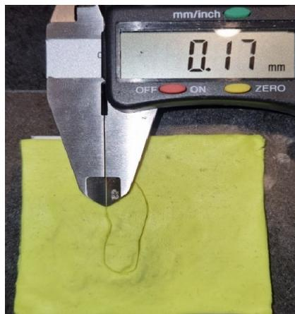
*Nota.* En la Figura 57 se observa el desfase que existe entre la primera y la cuarta prueba de troquelado en el molde 2, siendo este un valor de 0.17 mm.
