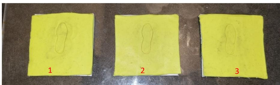
*Nota.* En la Figura 45 se encuentra la primera prueba de troquelado realizado, la cual será la guía para realizar las pruebas de precisión del molde en cuestión.
