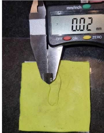
*Nota.* En la Figura 48 se observa el desfase que existe entre la primera y la segunda prueba de troquelado en el molde 2, siendo este un valor de 0.02 mm.
