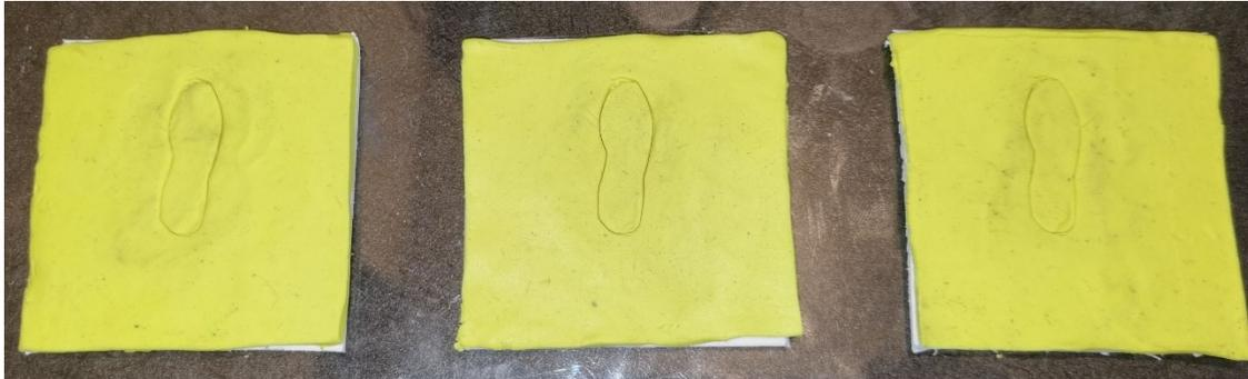
*Nota.* En la Figura 46 se encuentra la segunda prueba de troquelado en donde se puede evidenciar el troquelado del molde en la misma posición realizada la primera vez.
