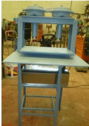
*Nota.* En la Figura 4 se puede observar una máquina de troquelado neumático de operación manual. Tomado de alternativa 3. Troquelado neumático (Cruz, 2016)
