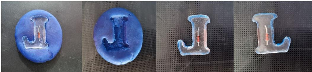
*Nota.* En la Figura 68 se puede observar el resultado final, comenzando desde la izquierda con la colocación de la resina en el molde troquelado, hacia la derecha culminando con el resultado final.
