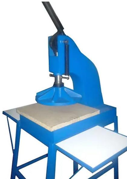
*Nota.* En la Figura 2 se observa una troqueladora manual de palanca de estructura reforzada.
