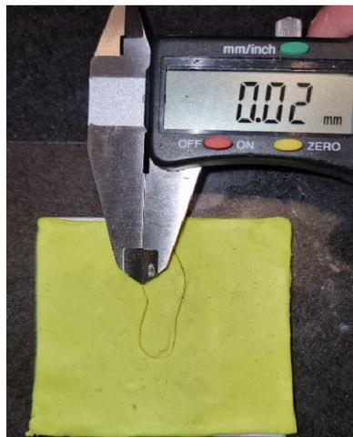
*Nota.* En la Figura 47 se observa el desfase que existe entre la primera y la segunda prueba de troquelado en el molde 1, siendo este un valor de 0.02 mm.
