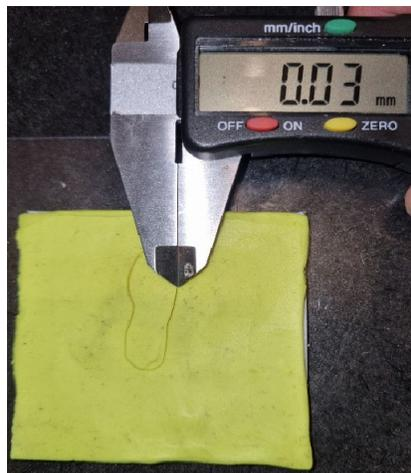
*Nota.* En la Figura 49 se observa el desfase que existe entre la primera y la segunda prueba de troquelado en el molde 3, siendo este un valor de 0.03 mm.
