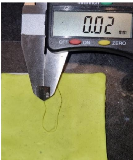
*Nota.* En la Figura 61 se observa el desfase que existe entre la primera y la quinta prueba de troquelado en el molde 2, siendo este un valor de 0.02 mm.
