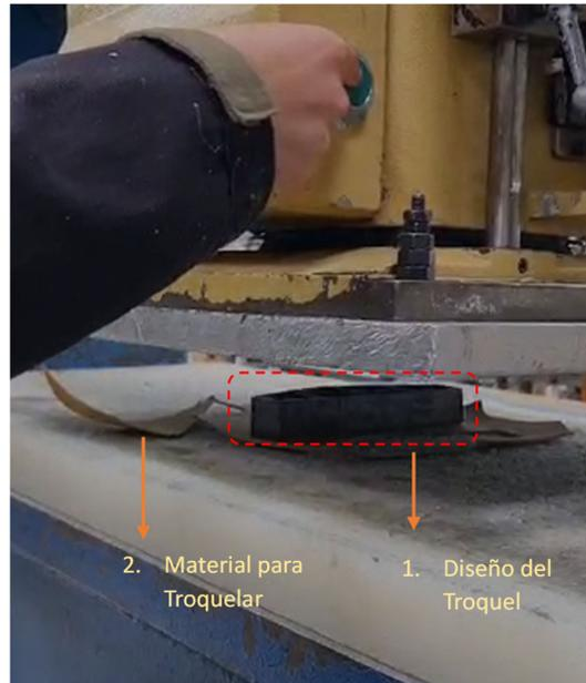
*Nota.* En la Figura 13 se logra visualizar que cada parte desempeña un papel crucial en el proceso de troquelado, asegurando que las piezas de cuero se corten de manera eficiente y precisa. 1. Es la herramienta afilada que realiza el corte en el cuero. Puede tener diferentes formas y tamaños según la aplicación. 2. La elección del tipo de cuero depende del estilo de calzado, la calidad deseada y las preferencias del fabricante y del consumidor.
