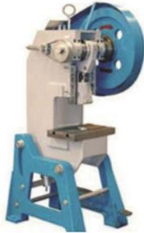
*Nota.* En la Figura 3 se puede observar una troqueladora mecánica de operación manual.
