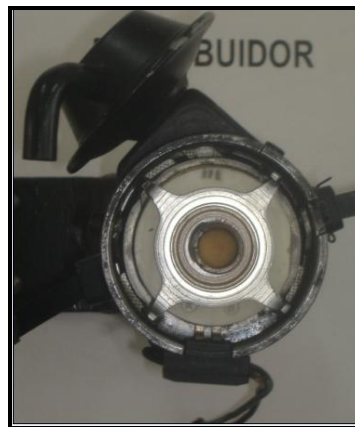
Figura 1.- distribuidor de generador de impulso
