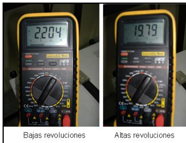
Figura 4.17.- Valores de voltaje en bajas y altas revoluciones
