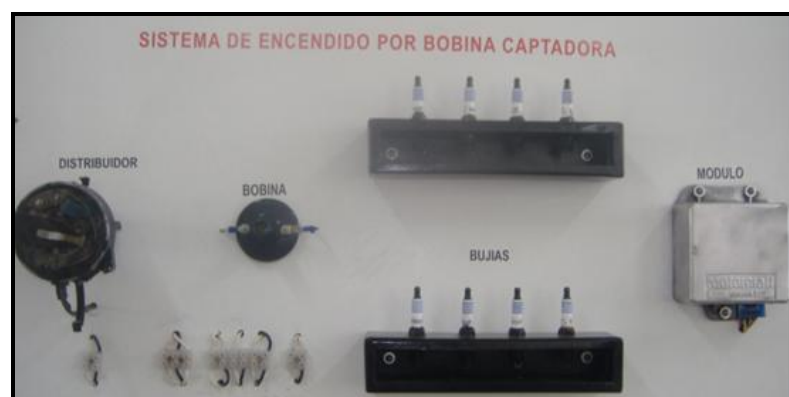
Figura 3.36.- Sistema por Bobina Captadora.
