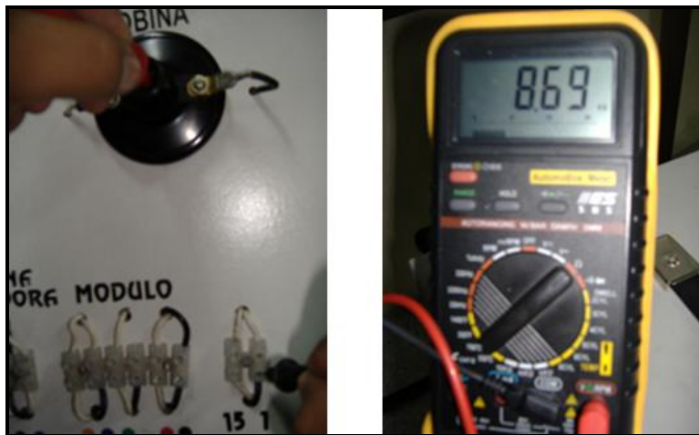
Figura 4.3.- Puntos de medición de resistencia del secundario de la bobina
