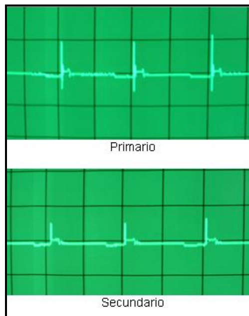
Figura 4.8.- Oscilogramas del primario y secundario del sistema de encendido
