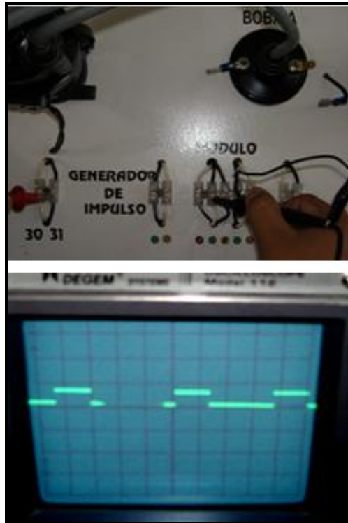
Figura 4.30.- Puntos de medición y oscilograma de salida del módulo
