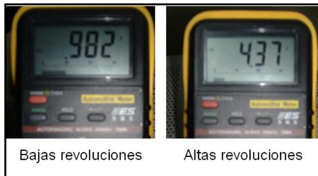
Figura 4.26.- Valores de voltaje en bajas y altas revoluciones
