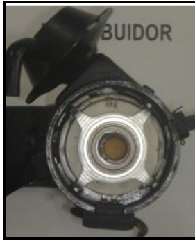
Figura 3.22.- Distribuidor con generador de impulsos
