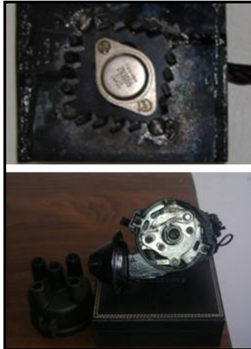
Figura 1.- Módulo y distribuidor transistorizado
