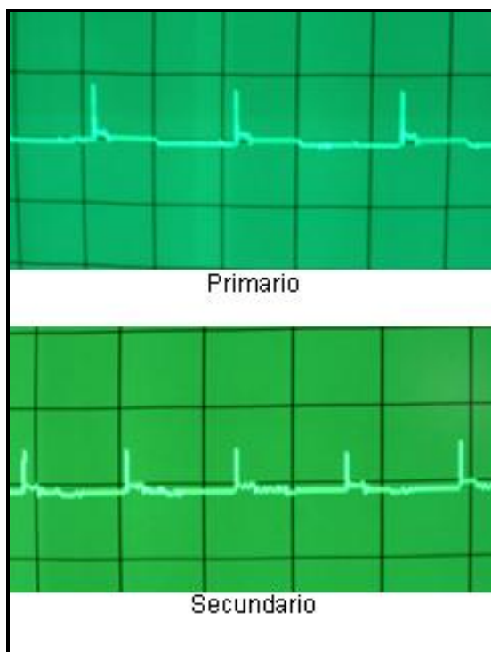
Figura 4.41.- Oscilogramas del primario y secundario del sistema de encendido
