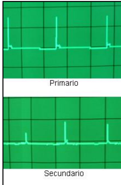
Figura 4.32.- Oscilogramas del primario y secundario del sistema de encendido
