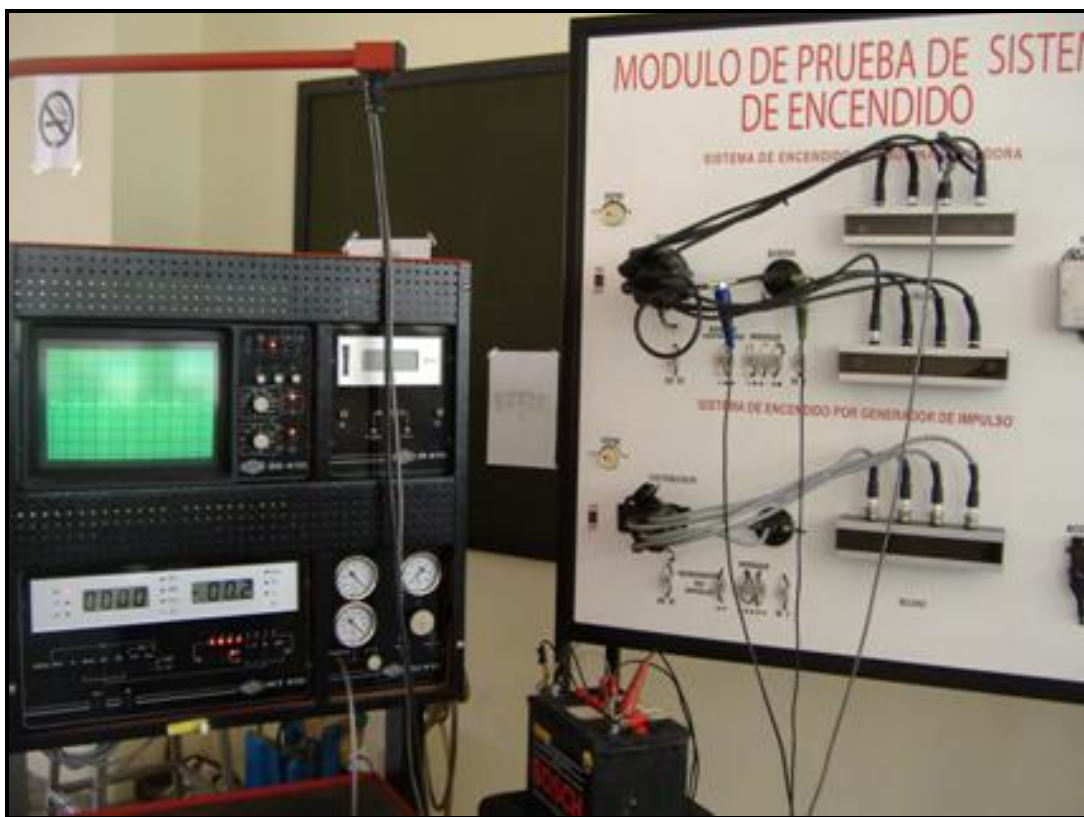
Figura 4.6.- Conexión de osciloscopio de alto voltaje
