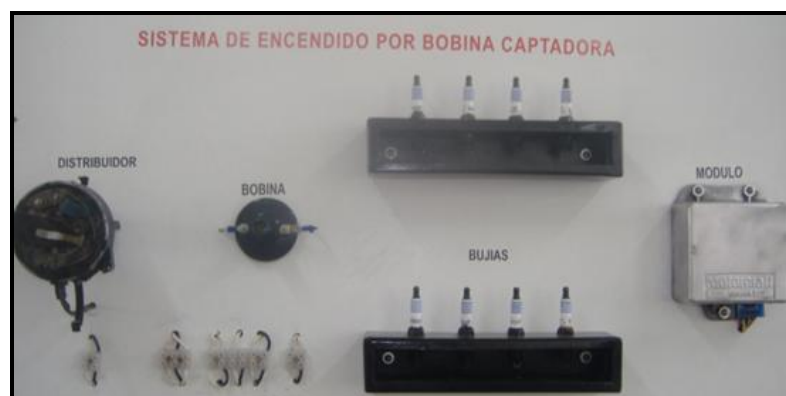
Figura 3.34.- Sistema por Bobina Captadora.
