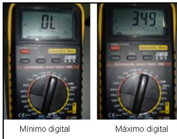
Figura 4.35.- Voltaje de salida del sensor hall
