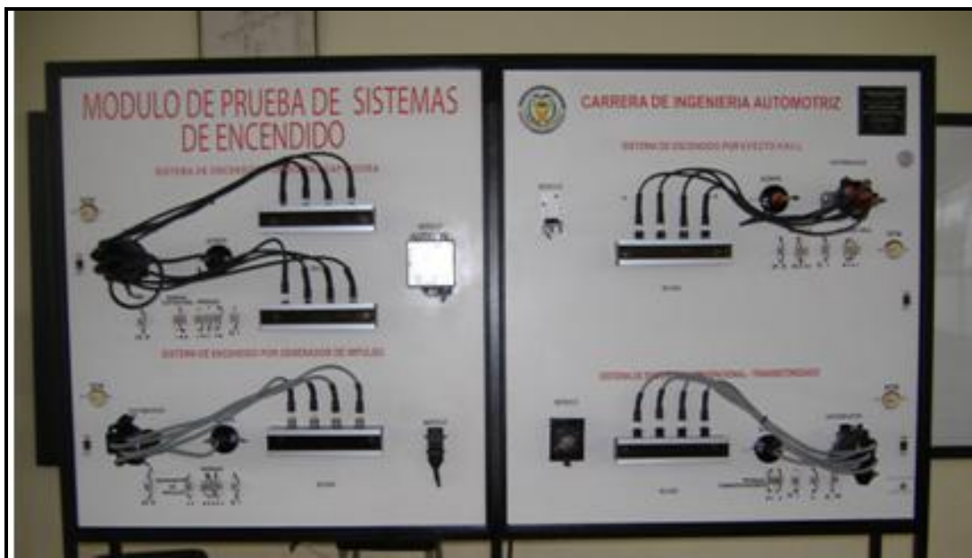
Figura 3.1.- Módulo de pruebas de sistemas de encendido
