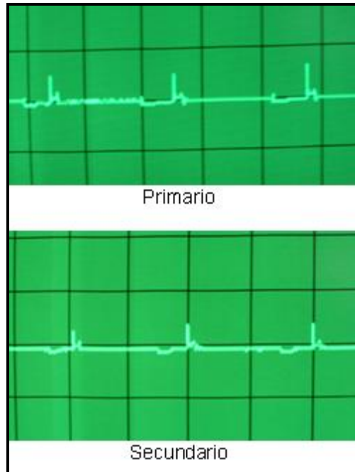
Figura 4.14.- Oscilogramas del primario y secundario del sistema de encendido
