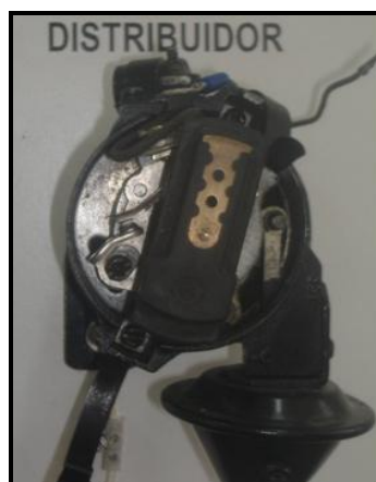
Figura 3.17.- Distribuidor con platino y condensa
