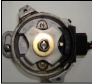
Figura 3.24.- Distribuidor con sensor hall
