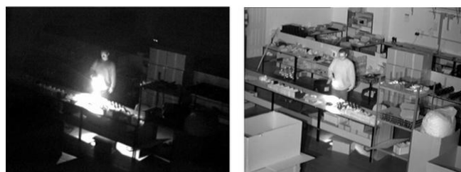
Figura 2.10: Comparación entre una imagen con ilustración infrarrojo y sin ilustración infrarrojo
