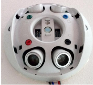
Figura 4.35: Vista interna del sensor OSC10-MOW
