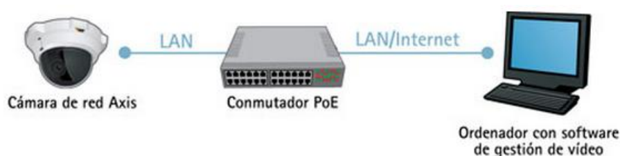
Figura 2.3: Cámara de red conectada directamente a la red LAN
