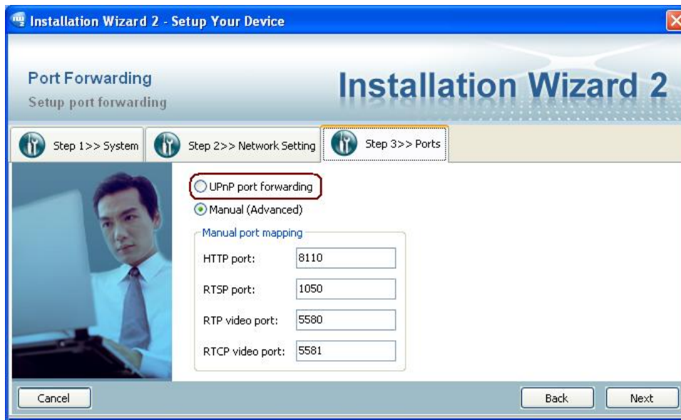
Figura 4.8: Paso 3, Configuración de los puertos UPnP
