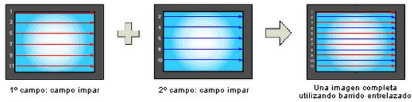
Figura 2.16: Imagen de barrido entrelazado mostrado en un monitor progresivo
