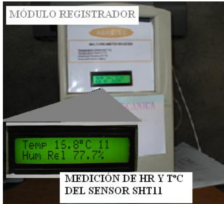
Figura 4.37 Medida de la humedad relativa y temperatura ambiente.
