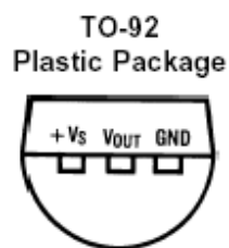
Figura 3.16 Distribución de pines del LM35.
