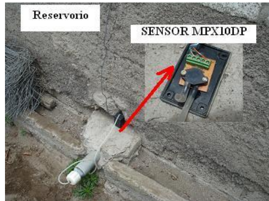
Figura 4.2 Ubicación física del transductor de nivel MPX10DP.
