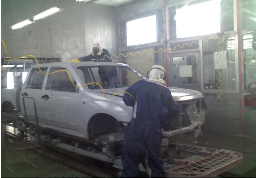
**Figura. II.18. Limpieza de carrocería**
