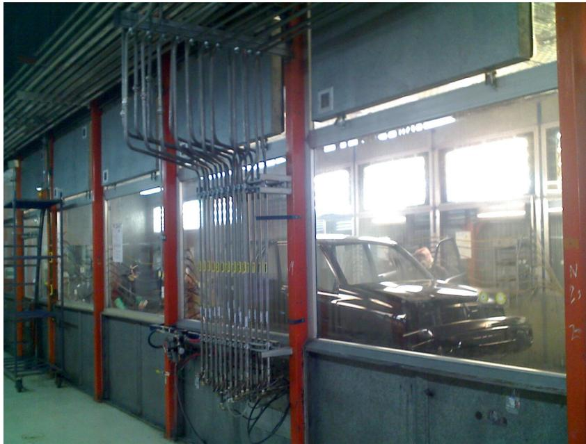
**Figura. II.19. Cabina de Color – Tuberías de pintura**
