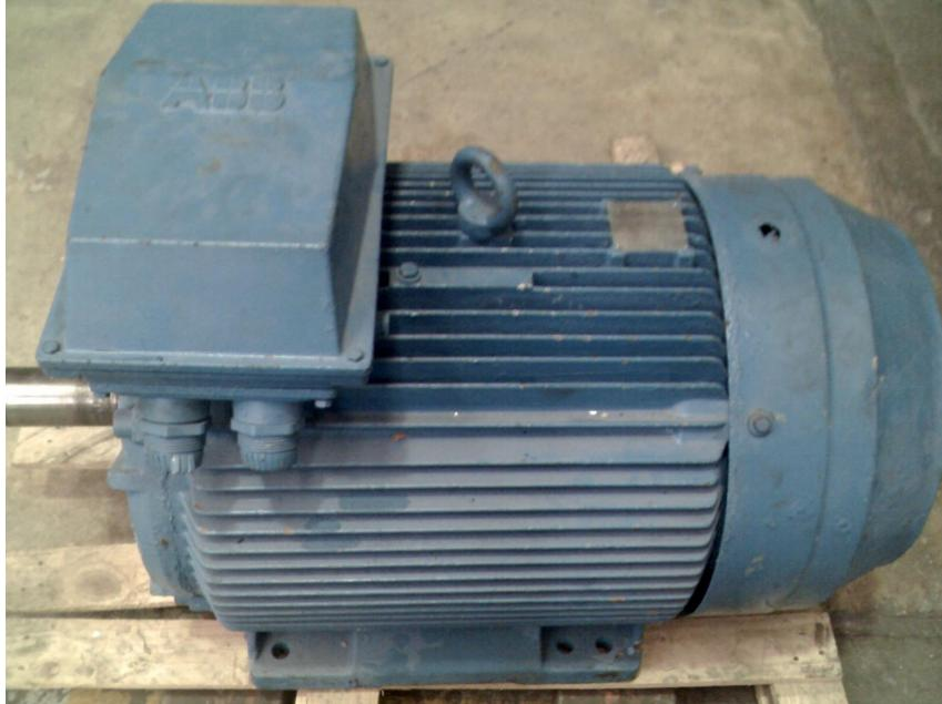
**Figura. II.45. Motor de conveyor**
