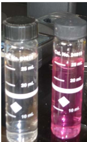
Figura 5.6: Muestra agua destilada, cloro Residual
