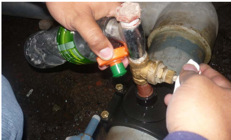
Figura 5.2: Muestra de agua, Tanque Cashapamba (salida)
