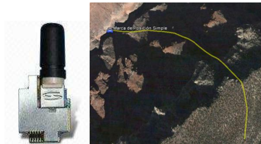
Figura 15 Ubicación geográfica del robot móvil a) Módulo receptor SPK-GPS-GS405 y b) Visualización de la ruta sobre el navegador Google Earth.
