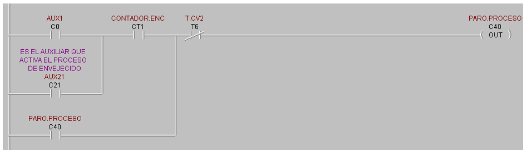
Figura 5.6.3. Proceso On/Off del quemador
