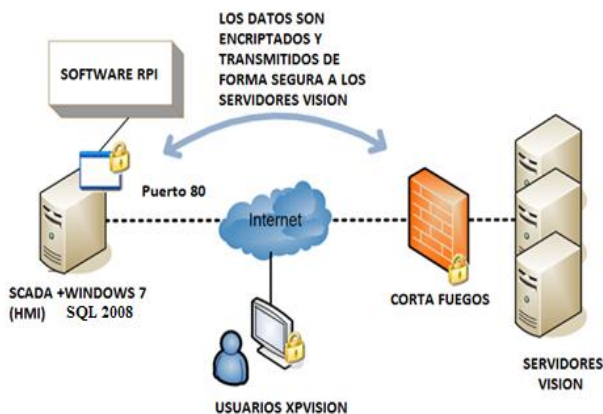
Fig. 7. Diagrama de transmisión de datos hacia los servidores Vision
