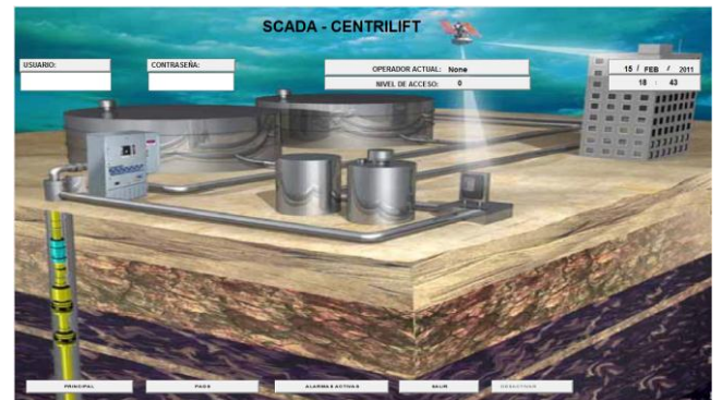
Fig. 3. Pantalla principal del SCADA
