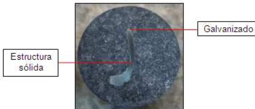
**Figura 7.35 Superficie pulida del electrodo sólido de alambre**
