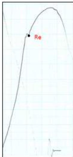
**Figura 7.16 Diagrama Carga – Desplazamiento del cabezal del perfil estructural C**
