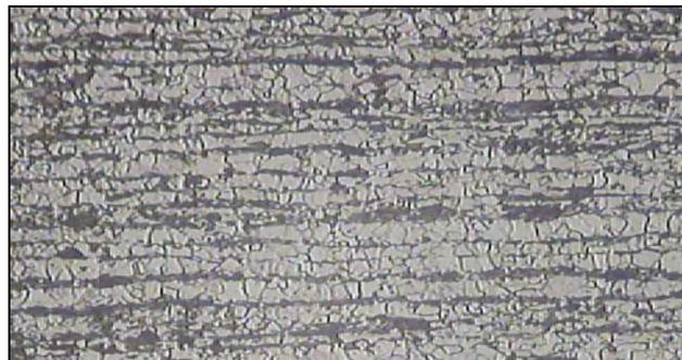
**Figura 7.19 Micrografía del perfil de arriostamiento 200X**
