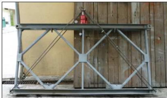
**Figura 3.2 Ensayo de flexión del cordón superior del panel tipo Bailey**
