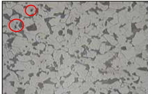
**Figura 7.7 Micrografía del bulón de panel 100X**
