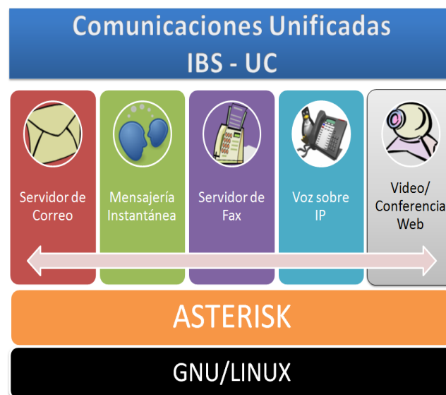
Figura 4.23: Gráfico de Arquitectura del Producto Telefonía IP 90 .
