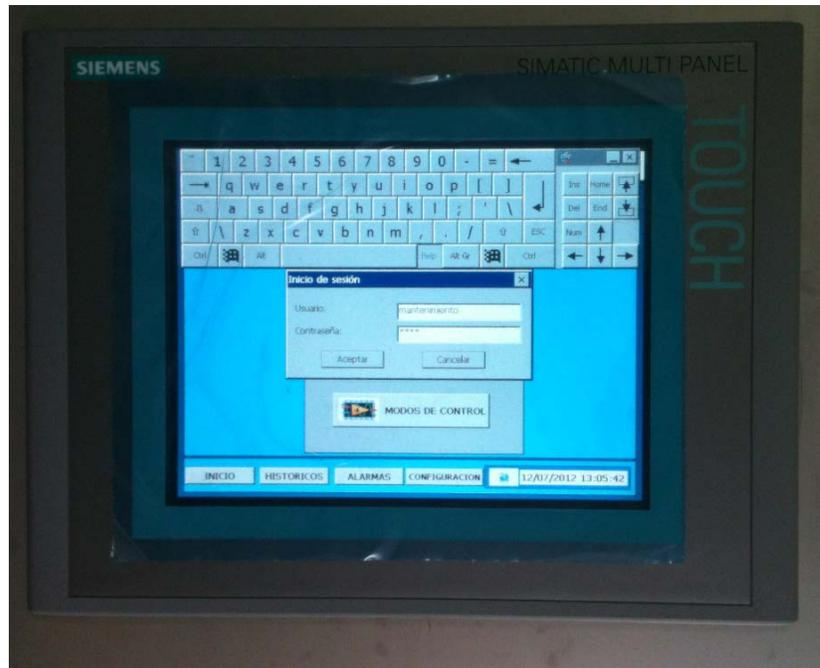
**Figura 6. 29. Verificación del control de acceso**
