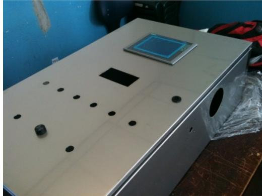
**Figura 5. 38. Panel de operador montado en el armario**
