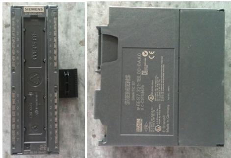
Figura 5. 4. Módulo de entradas digitales SIEMENS SM 321
