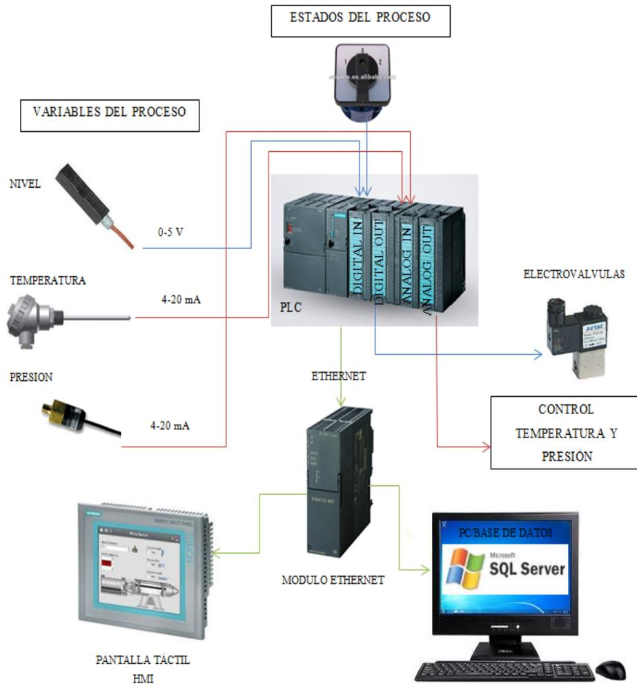
Figura 3. 1. Diagrama explicativo del diseño del Hardware de supervisión
