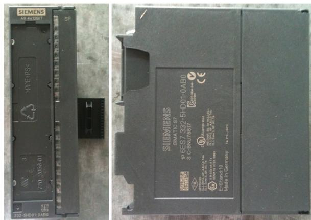
Figura 5. 7. Módulo de salidas analógicas SIEMENS SM 332
