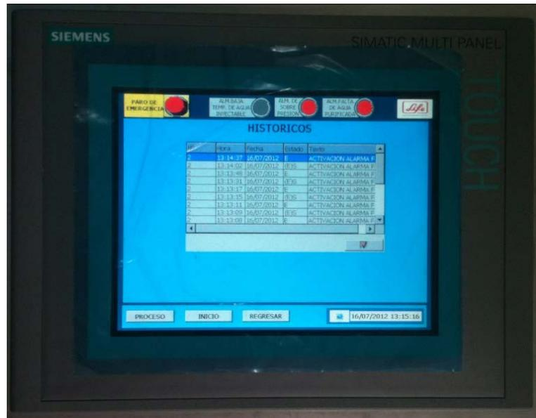
Figura 6. 32. Verificación de las situaciones de emergencia del proceso
