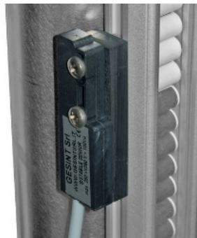
**Figura 5. 11. Sensor de nivel tipo biestable magnético**
