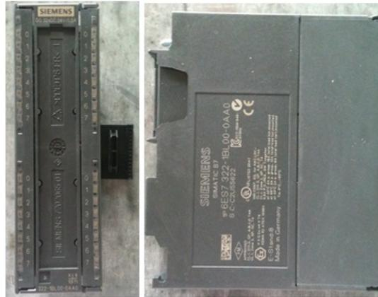
**Figura 5. 5. Módulo de salidas digitales SIEMENS SM 322**
