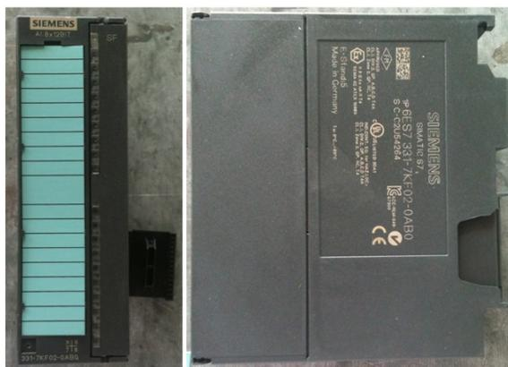
**Figura 5. 6. Módulo de entradas analógicas SIEMENS SM 331**
