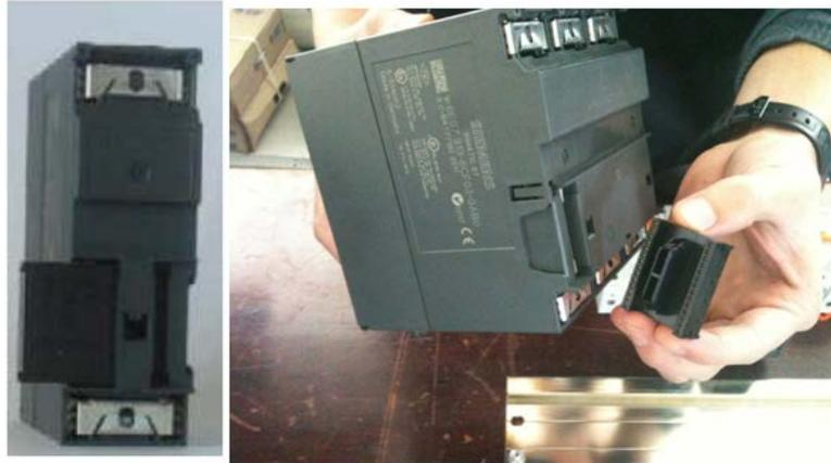
**Figura 5. 28. Módulos con soporte (conector de bus)**
