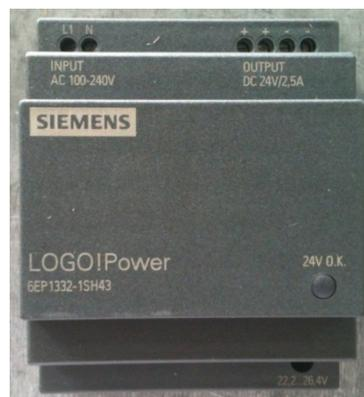
Figura 5. 13. Fuente de alimentación SIEMENS de 24 VDC
