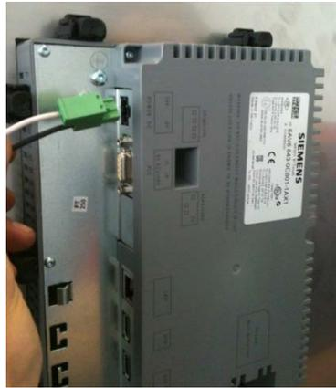
**Figura 5. 40. Alimentación del panel de operador**
