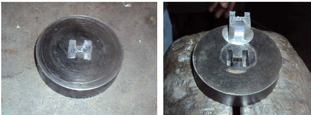
Figura 6.10 Extracción de material en dado I 70 .
