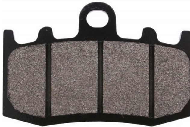
Figura 2.1 Pastilla de freno de material cerámico sinterizado 1
