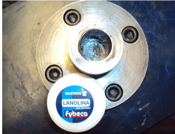
Figura 6.2 Correcta lubricación de cada elemento antes de realizar la extrusión 62 .
