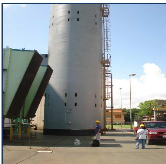
Figura 52. *Medición de Calidad de Aire Ambiente y Nivel de Presión Sonora*
