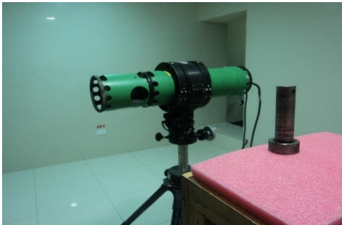
Fig. 7. Ubicación del pin de sujeción a la distancia calculada.
