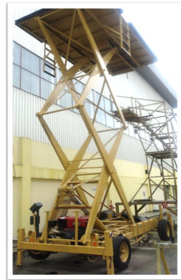
Fig. 13. Plataforma Elevadora terminada
