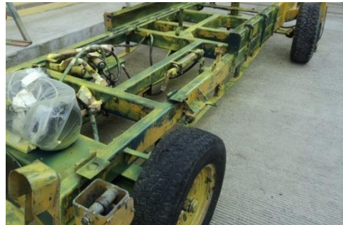
Proceso anticorrosivo con Primer
