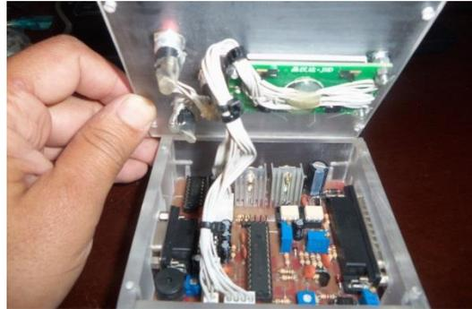
Figura 7.- Montaje de los elementos electrónicos
