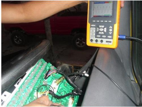
Figura 10.- Búsqueda de la señal de la velocidad angular
