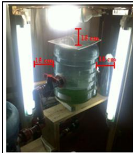
Figura 5 Sistema de iluminación encendido.
