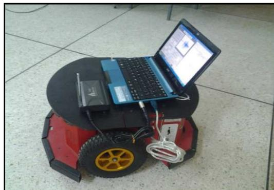
**Figura. 3.8 Interfaz MATLAB-ARIA conectada con el robot físico**
