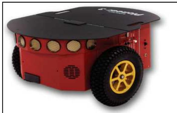
**Figura. 2.1 Robot Pioneer 3-DX**
