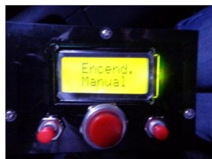
Por defecto, el modo manual está programado para comenzar en luces bajas. En este modo se puede calibrar los valores de **Intensidad Luminosa**, **Posición Vertical** y **Posición horizontal** de los faros.
