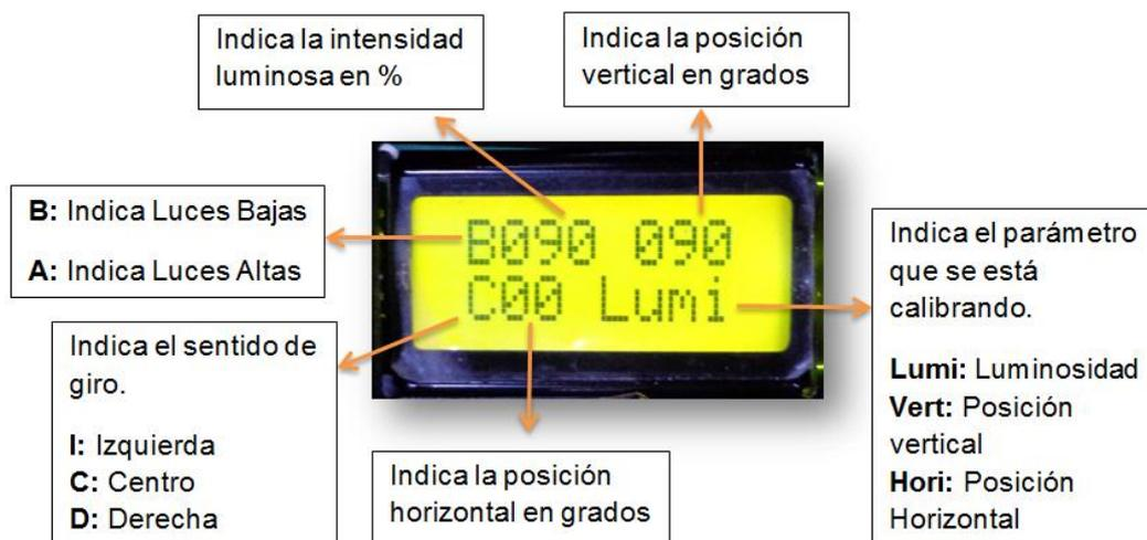
Para hacer el cambio de luces presione instantáneamente el **botón 2 de selección**. La intensidad luminosa y la posición vertical en bajas están programadas para que no sobrepasen los valores configurados en luces altas.
