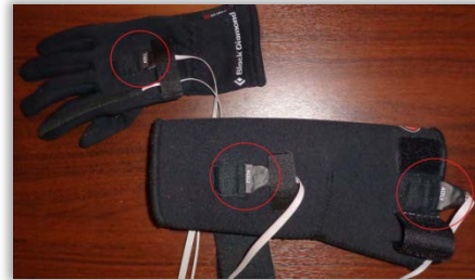
Figura 7: Acelerómetros ubicados sobre el guante.
