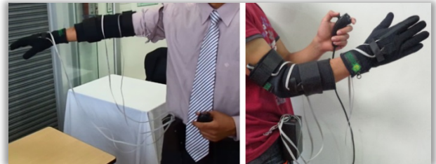
Figura 11: Operador colocado el guante sensorizado.
