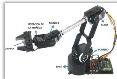
Figura 2: Brazo robótico Lynxmotion AL5D con sus articulaciones.
