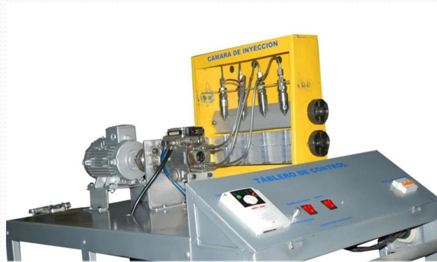
*Este banco de pruebas utiliza un módulo electrónico que esta implementado en los vehículos convencionales pero para el efecto del banco de pruebas no se utiliza todos sus pines de conexión si no los necesarios para la conexión de la VP44.*
