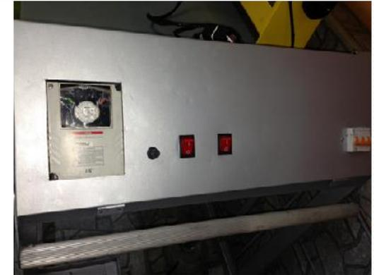
Se colocó los interruptores de encendido que nos permiten activar el sistema eléctrico de la bomba de combustible y dar corriente a la ECU
