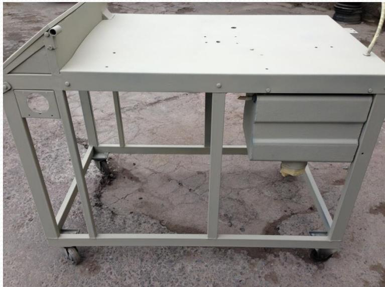
2. Instalación de los elementos de inyección y de medición de combustible se utilizo una estructura metálica en la cual van instaladas dos platinas :
