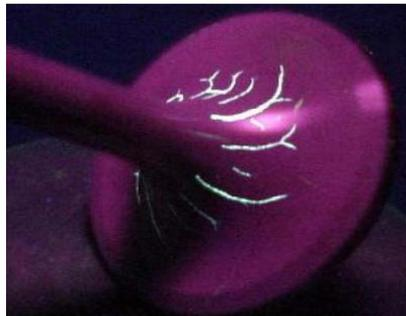
Figura 2.2 Examinación con penetrante Fluorescente
