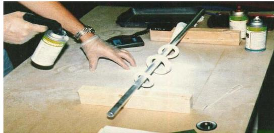
Figura 3.8 Aplicación del revelador
