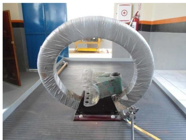
Figura 3.35 Magnetización con bobina
