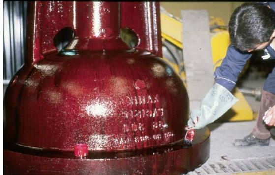
Figura 2.3 Examinación con penetrante visible
