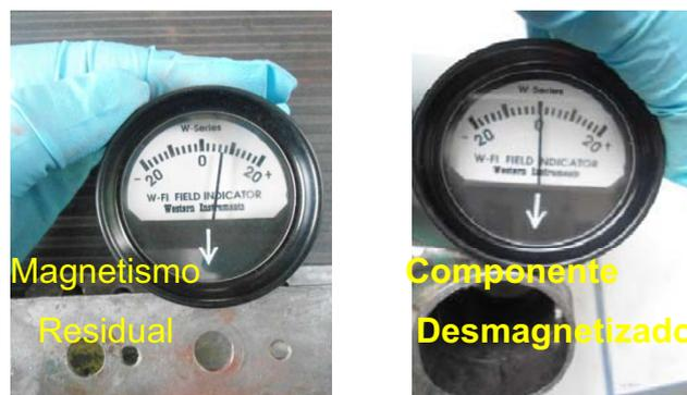
Figura 3.45 Comprobación de campo magnético residual
