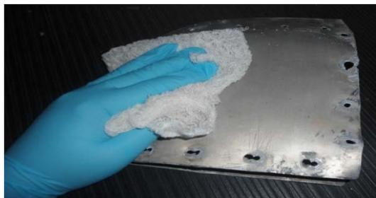
Figura 3.26 Limpieza del Componente
