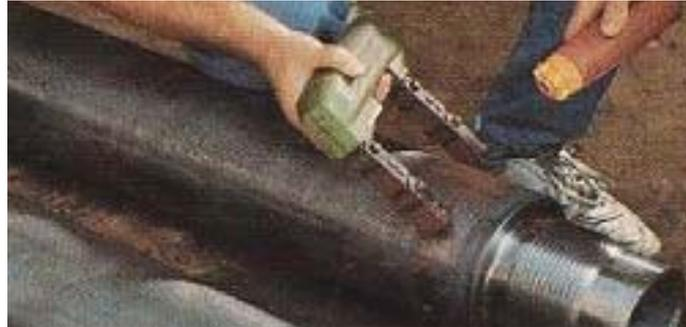
Figura 3.20 Inspección por Partículas Magnéticas Secas
