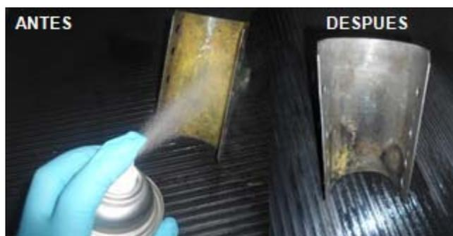
Figura 3.31 Preparación de la superficie
