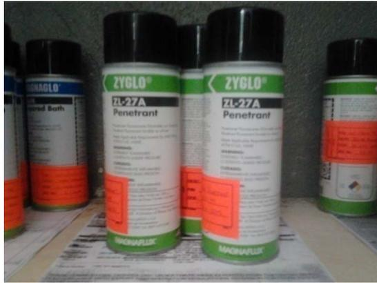
Fig. 4.2 Líquido Penetrante
