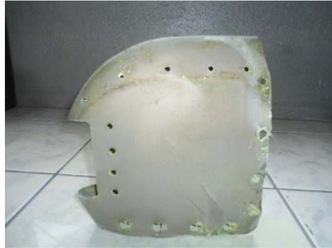
Figura 3.29 Aplicación del Revelador
