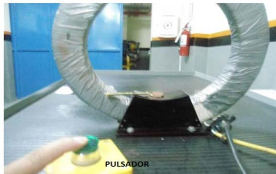
Figura 3.36 Magnetización del componente
