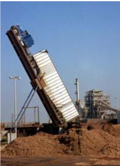
Fotografía cortesía de DOE/NREL , Andrew Carlin, fotógrafos operadores de Tracy Camión descargando trozos de madera que servirán como
