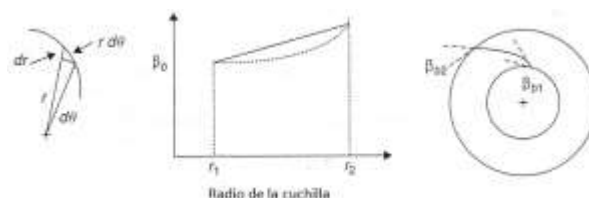
FIGURA 11 Distribución del ángulo de la hoja para el diseño preliminar.
